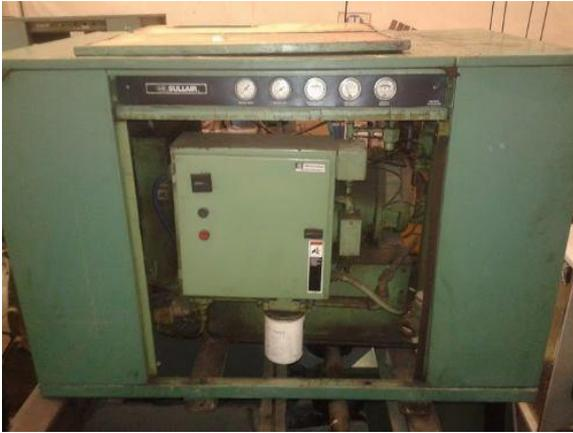
Foto 1.5 Compresor eléctrico a tornillo
