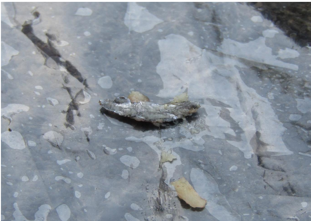
Foto 74: Pieza de plomo recuperada de la cavidad permanente. Esta figura achatada y completamente deformada es lo que queda de la munición de punta plana, que, sin haber sido diseñada para penetrar múltiples capas de tejido, termino por deformarse en su totalidad.
