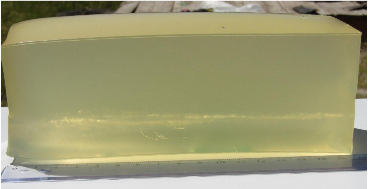
Foto 32: Cavity permanente producto de la trayectoria recorrida por la munición slug dentro del bloque de gel balístico, se puede apreciar una expansión al inicio del recorrido seguida de un recorrido uniforme.
