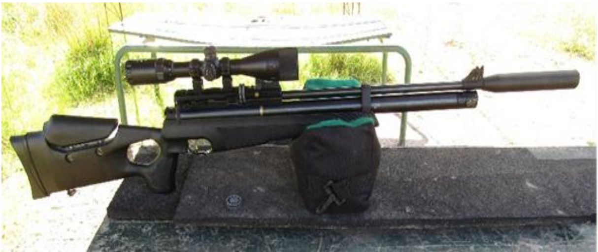
Foto 7: Rifle neumático de tipo P.C.P. Hatsan "AT44 - 10" en calibre 5.5mm empleado para efectuar las experimentaciones. Se puede apreciar el almacén tubular de aire comprimido por debajo del cañón.
