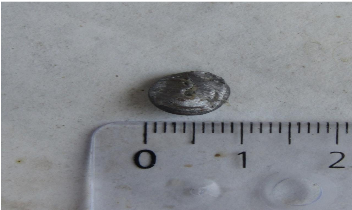
Foto 68: Proyectil de punta hueca recuperado de la cavidad permanente. Se comprueba la naturaleza expansiva de este al haberse dado una deformación total, donde la pieza final acaba con un diámetro total de casi 1 centímetro, el doble del calibre original.
