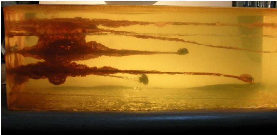
Imagen de un bloque de gel balístico al momento del impacto por múltiples proyectiles, nótese como se preservan las cavidades y, al momento de tomarse la fotografía, se observa una representación de la cavidad temporal provocada. Imagen recuperada de: https://www.armas.es/peligros-de-la-sobrepeneracion-en-la-municion-policial
