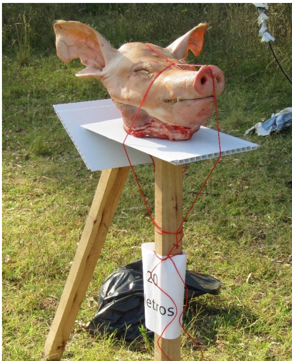
Izquierda: Montaje de la cabeza de cerdo sobre los soportes plásticos, antes de propinársele los disparos. Derecha: Pieza de cerdo recuperada de los soportes posterior a ser efectuados los disparos, se pueden ver marcados con rotulador negro los orificios de entrada para dos de los proyectiles empleados.
