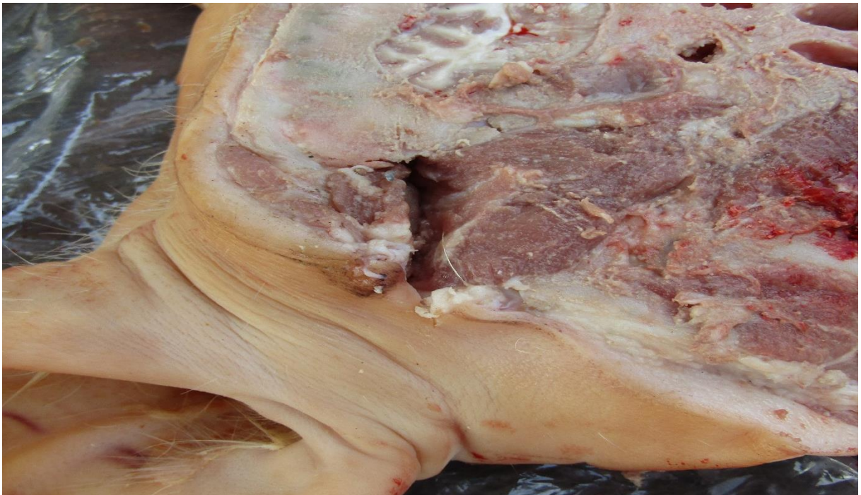
Foto 64: Cavity permanente causada por el recorrido de la munición dentro del tejido, se aprecia un agrandamiento del orificio producto de la expansión del proyectil.
