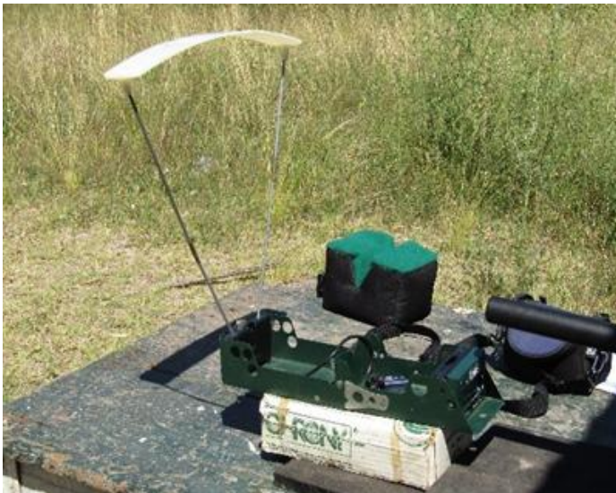
Foto 8 y 9: Arriba, cronógrafo abierto y preparado para registrar velocidades de salida de la munición, se puede ver la boca del cañón casi sobre el sensor del dispositivo. A la derecha, banco y campo de tiro previos a la primera serie de disparos. Se pueden ver el sistema que componen el rifle con el cronógrafo y la estaca con el bloque a diez (10) metros.
