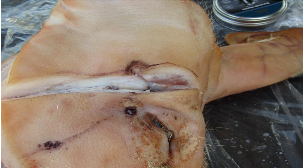
Foto 63: Área de impacto para la munición de punta hueca, marcada con rotulador de color negro y abierta de manera transversal a modo de inspeccionar los efectos de esta.
