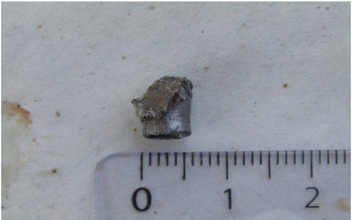
Foto 81: Munición de tipo slug recuperada de la cavidad analizada. Se denota en este caso la deformación de la punta de este en un solo lado, con signos de arrastramiento contra material duro, que habría sido el hueso. Así se dictamina el efecto de rebote dado.
