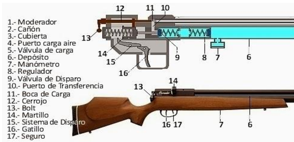
Piezas componentes del sistema de disparo de un rifle P.C.P. Imagen recuperada de: https://airenlaces.blogspot.com/2013/11/rifles-de-aire-pcp.html
