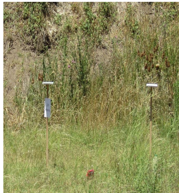
Conjunto de soportes dispuestos para la realización de las pruebas. Uno sería el que tendría el bloque de gel y el otro mantendría la cámara fotográfica.
