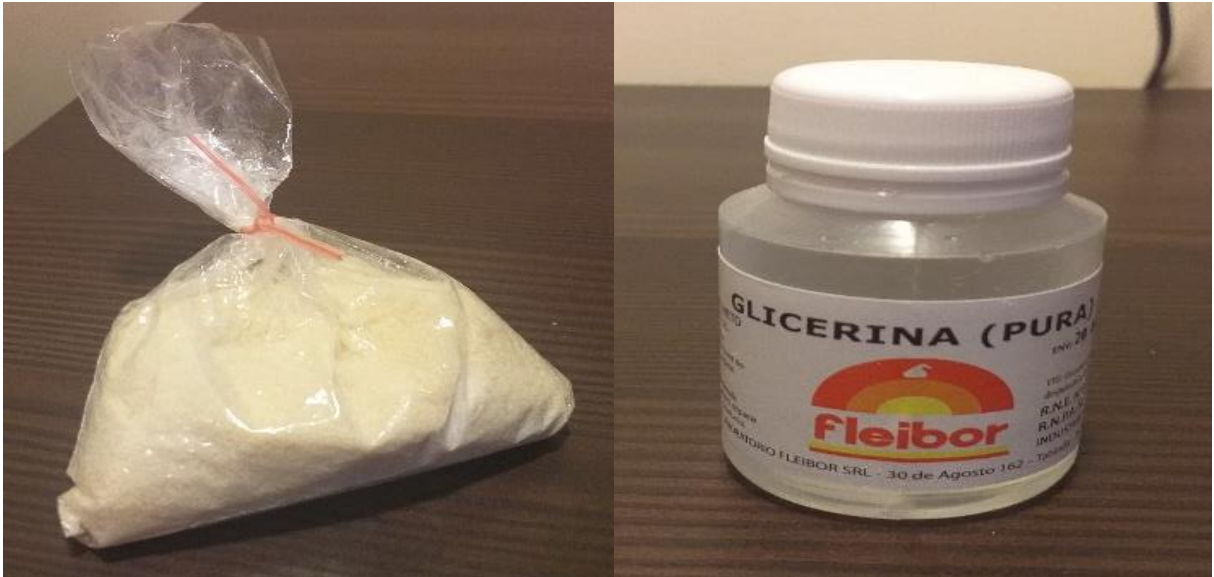
Gelatina sin sabor y glicerina utilizadas para la creación de los bloques de gel.
