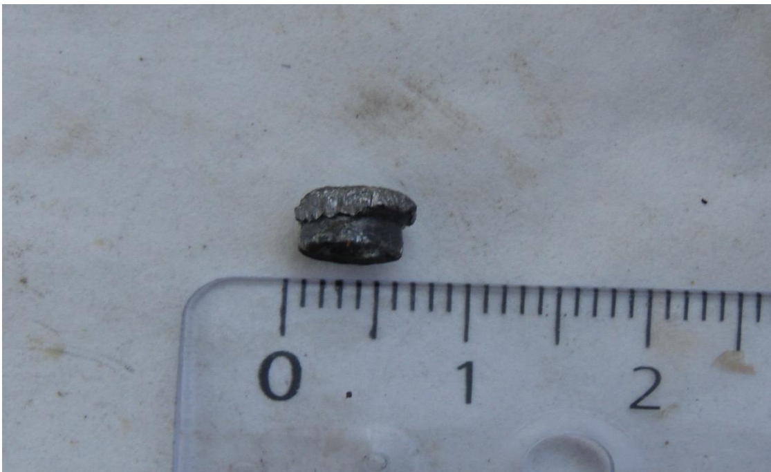
Foto 62: Medición longitudinal del proyectil recuperado. Se observa para este caso una deformación total de la punta y cuerpo de la munición, producto de su recorrido dentro del tejido porcino. Ante todo, mantiene su calibre de 0.5 centímetros, siendo ínfima su expansión dentro del cuerpo.
