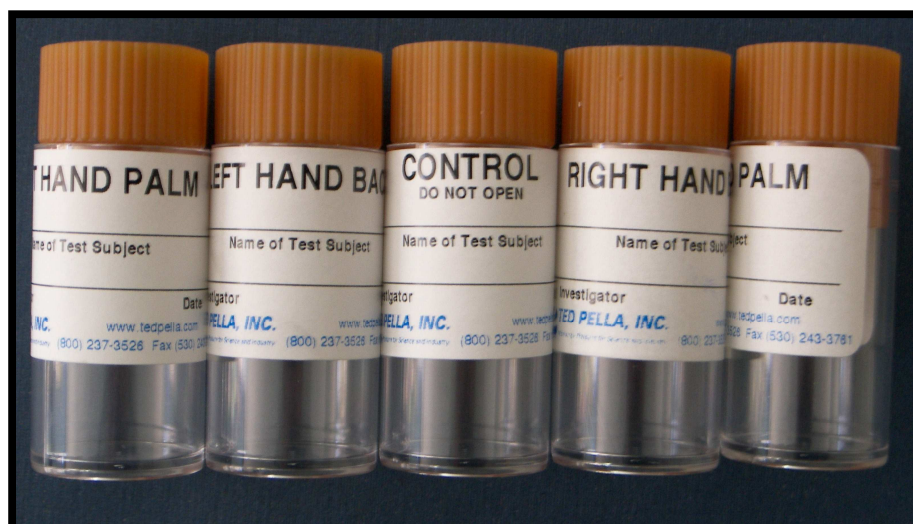
Figura N° 43: Fotografía obtenida de recipientes contenedores de la muestra, aclarándose que son utilizados dos por cada mano, uno para la palma y el otro para el dorso de la mano y el quinto integrante del kit es utilizado como muestra control.
