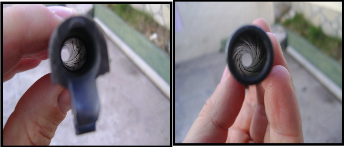
Figura N° 10: Fotografía obtenida del cañón de una pistola FM calibre 9 mm dónde se observa el aposentamiento de partículas negruzcas producto de los residuos dejados por la pólvora luego de producirse un disparo.
