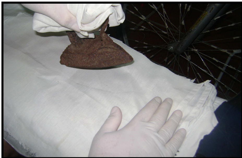
Figura N° 24: Fotografía obtenida durante el proceso de lanchado efectuado a la prenda con residuos de disparos observada en la fotografía anterior.
