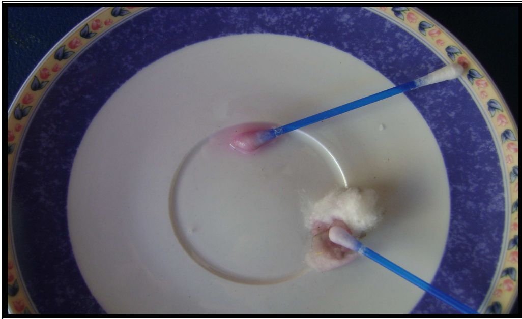
Figura N° 17: Fotografía obtenida de la reacción del ácido sulfanílico y el alfa naftilamina positiva para la presencia del ión nitrito.
