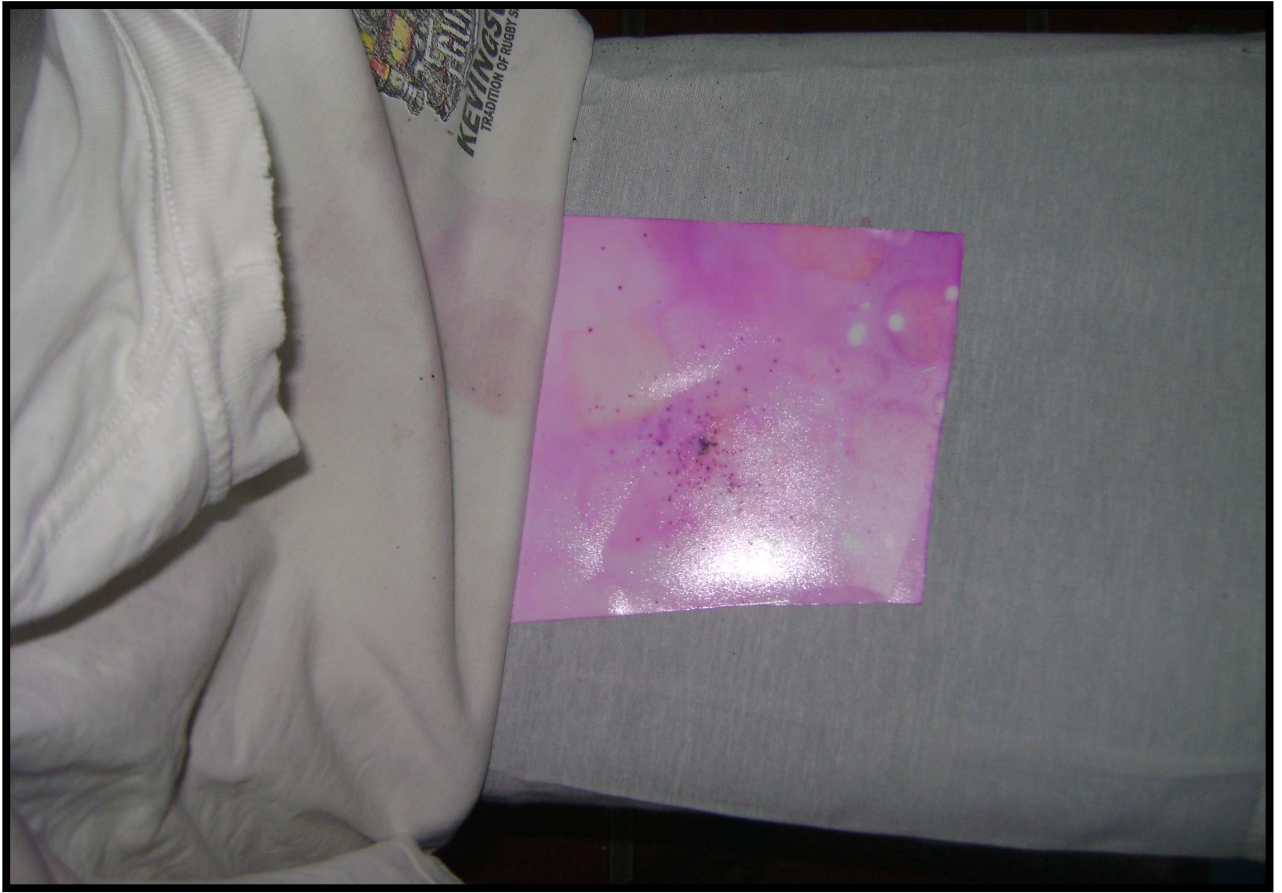
Figura N° 25: Fotografía obtenida de la reacción generada sobre el papel fotográfico desensibilizado, luego del proceso de “planchado”.-
