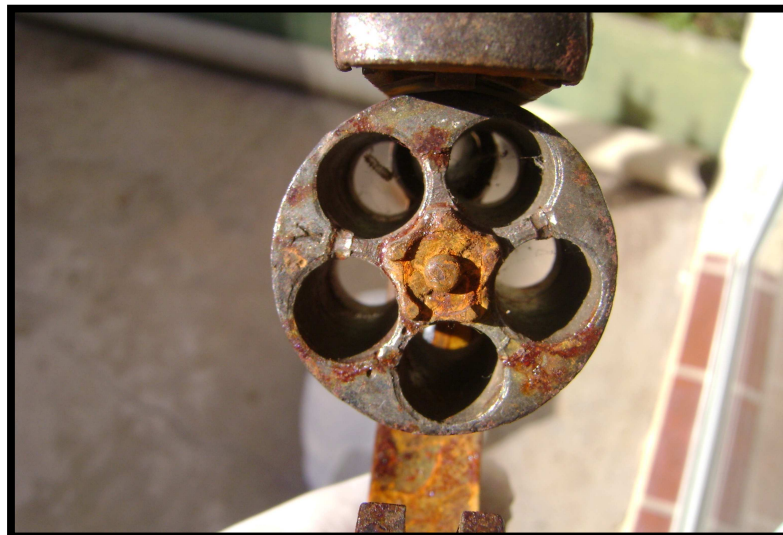
Figura N°12 : Fotografía obtenida del interior del cañón de un revolver calibre .32 largo, observándose el aposentamiento de residuos carbonosos producto de los restos dejados por la deflagración de la pólvora.
