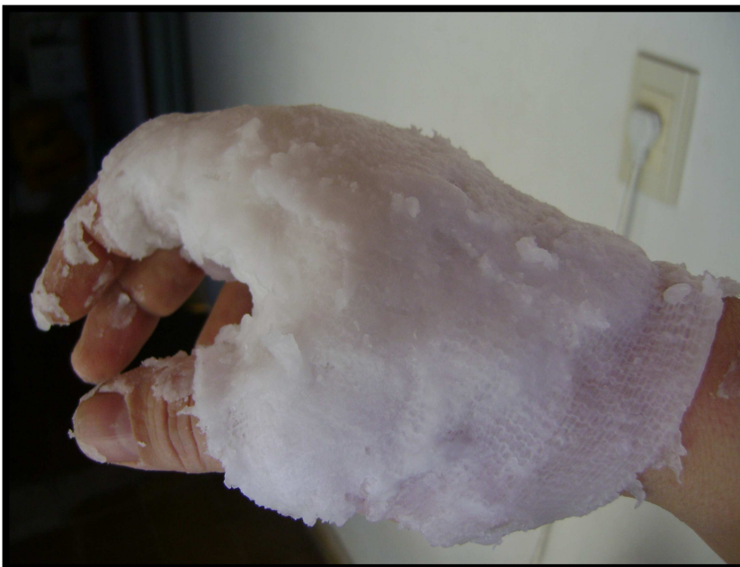
Figura 18: Fotografía obtenida del “guante” de parafina efectuado sobre la mano de un presunto tirador.
