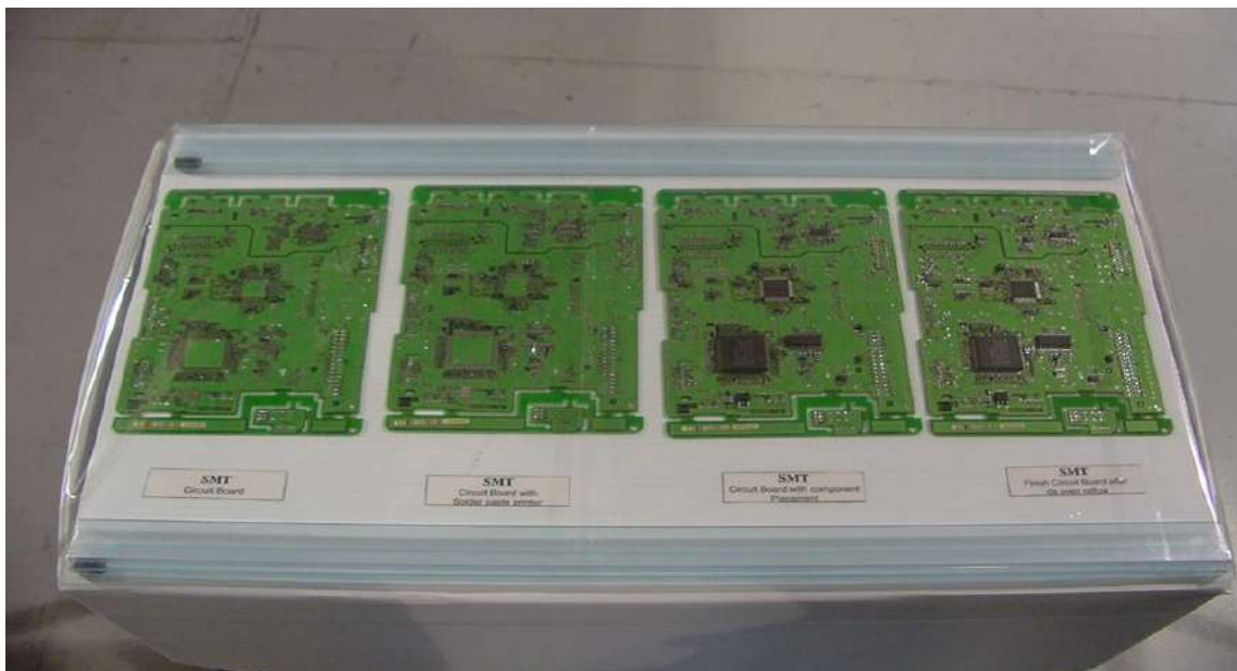
Placa electrónica del controlador de motor.
