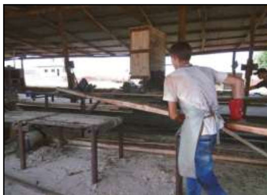
Figura 3.23.: Traspaso de materia prima de la sierra circular a la sierra sinfín secundaria tableadora, Aserradero.
