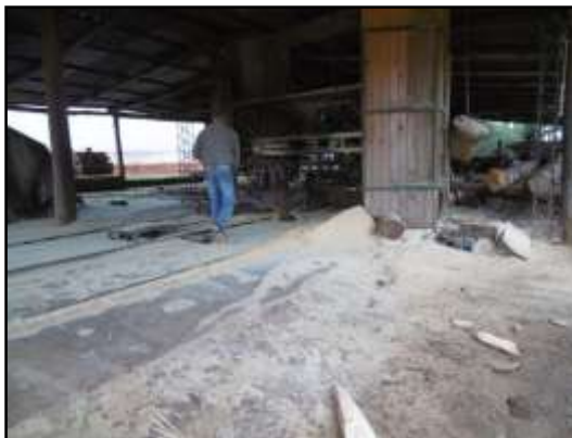
Figura 3.17.: Limpieza de residuos de aserrín con pala de madera conduciendo a la cinta conducto para eliminación del mismo, Aserradero.
