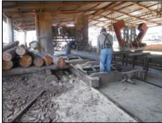
Figura 3.16.: Posicionamiento de rollos y posterior sujeción primeros cortes, Aserradero.
