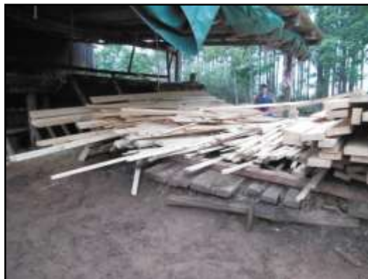
Figura 3.28.: Tarima de acopio de madera luego del baño de tratamiento y zona de clasificación, Aserradero.
