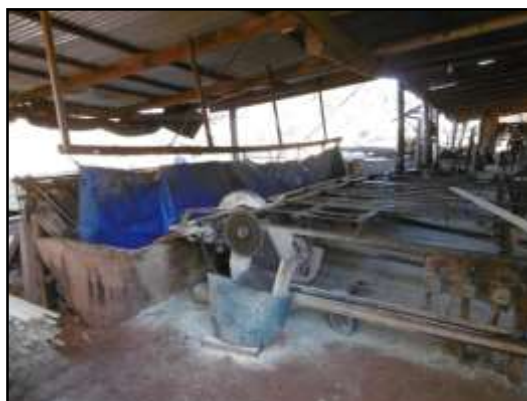
Figura 3.26.: Zona de transición entre la maquina sierra circular despuntadora y la pileta de curación, Aserradero.
