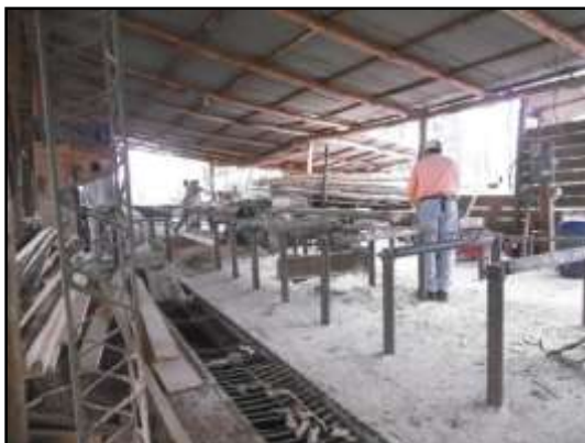
Figura 3.20.: Corte sierra circular tableadora y descarte de costaneros, Aserradero.
