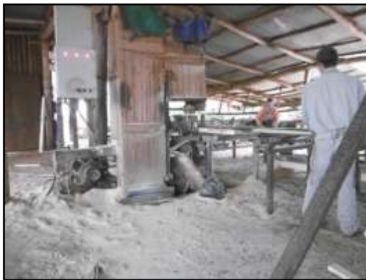
Figura 3.23.: Traspaso de materia prima de la sierra circular a la sierra sinfín secundaria tableadora, Aserradero.
