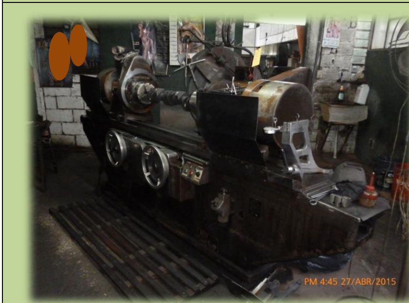
Otro equipo de rectificado con sus protecciones correspondientes
