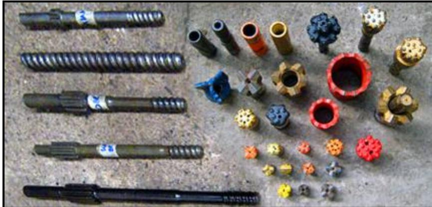
**Fig 17: Accesorios de Perforación**
