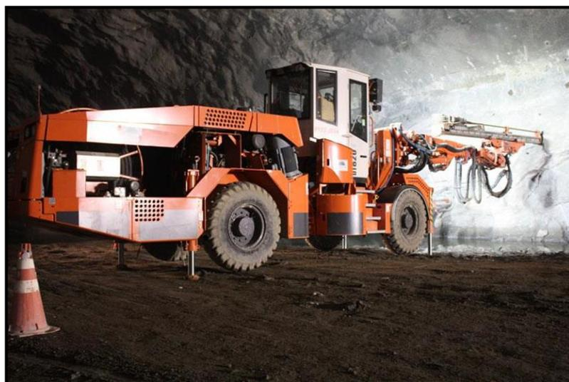
**Fig. 24: Posición final del Jumbo, fin de la perforación**
