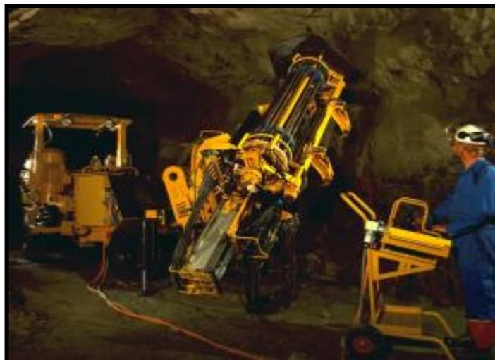
✚ **Perforación de producción:** Término utilizado en las explotaciones mineras a trabajos de extracción de mineral (estéril). Los equipos y métodos varían según el sistema de explotación. (Fig. 17)
