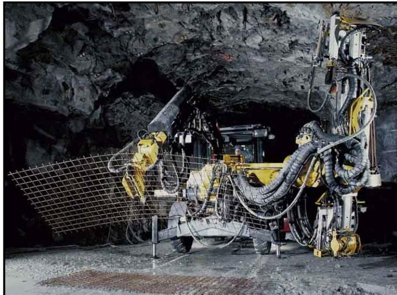
**Fig 20: Perforación para sostenimiento de roca**
