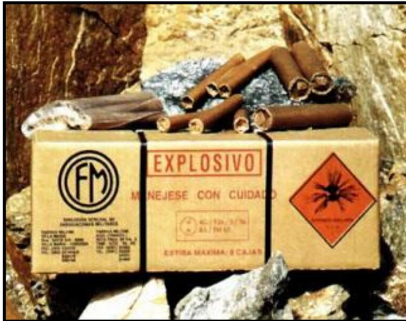
***Fig 57: Caja de gelamon (explosivos) utilizado en voladura de galerías.***
