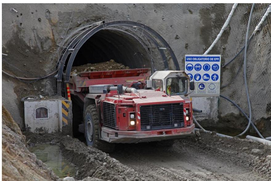
**Fig. 36: Camiones Dumper se traslada desde interior mina a superficie**
