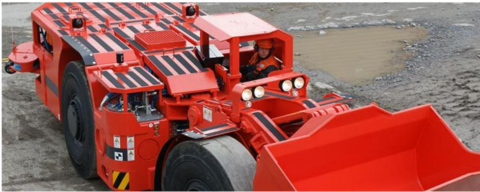
**Fig 49: Posición del operador en el Scooptrams- pala de bajo perfil**
