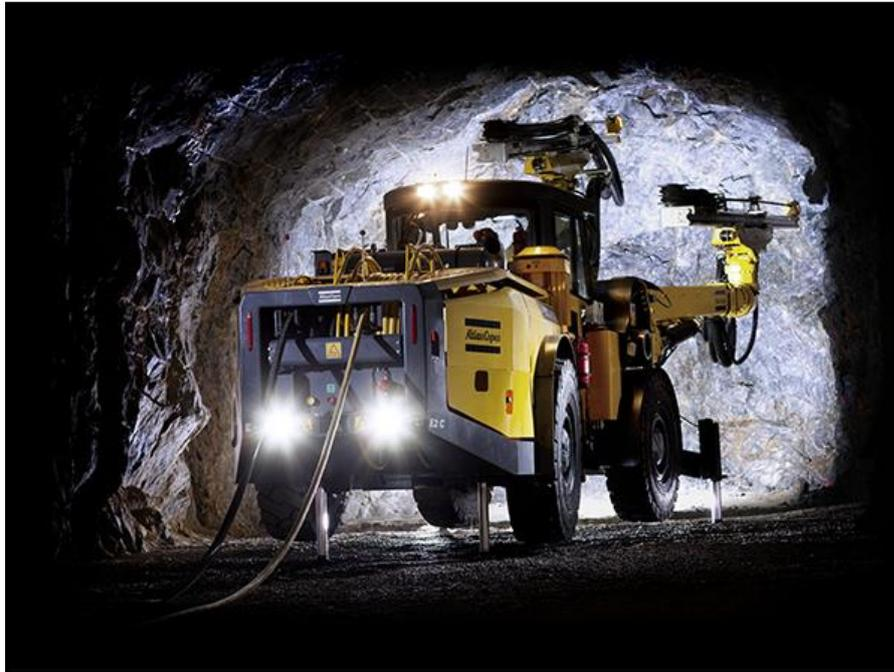
**Fig 21: Perforación de avance de túneles galerías o rampas**
