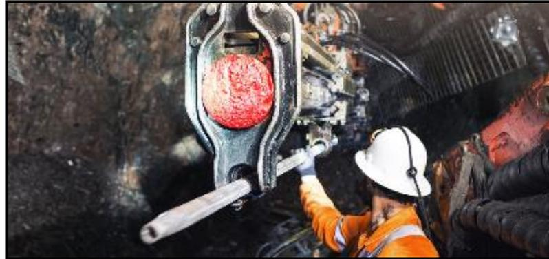
**Fig. 23: Cambio de barreno y brocas de perforación**
