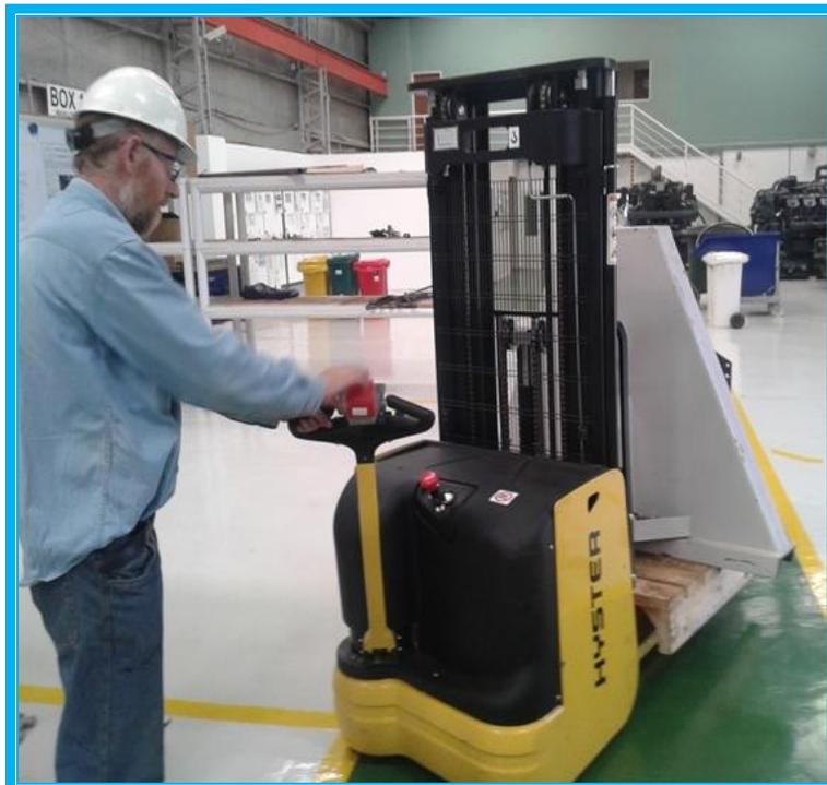
Otra parte importante del proceso y la manipulación de cargas es la zona de tapas de cilindros, una vez que se retiran del motor, se colocan en pallet y se las mueve con un auto elevador hasta la zona de reparación, allí se las iza por medio de un puente grúa y se las deposita en una mesa con rodamientos que permite trasladarlas fácilmente.
