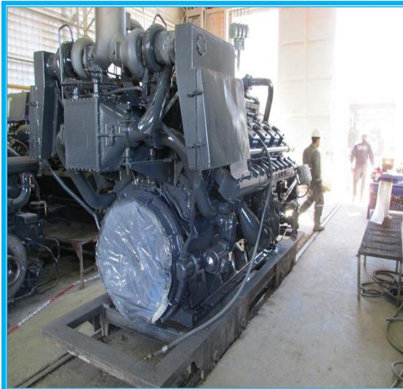
Posteriormente y luego de ser lavado, se procede al desarme, retirando tapas de cilindros, conjuntos de camisa y pistón, bielas, cigüeñal, etc.,
