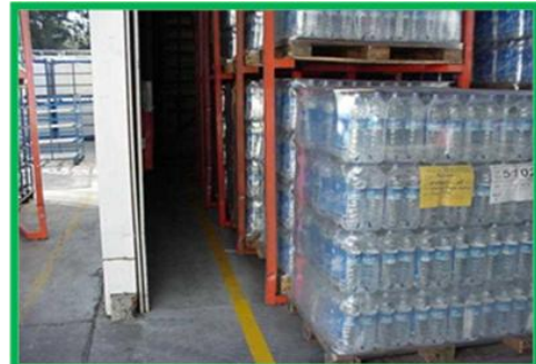
La separación del producto y la pared facilitan la higiene y mejoran la aireación del depósito.
