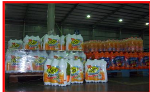
Para evitar contaminaciones el producto debe estar separado del piso.
