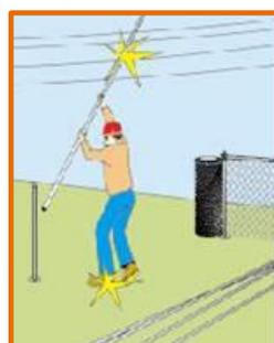
Las descargas eléctricas y electrocuciones suceden cuando no se cuenta con las barreras físicas para prevenir el contacto con cables o partes bajo tensión. De este modo, cuando camiones de cantera, grúas, plataformas de trabajo, u otras, materiales conductores (tales como caños, escaleras, o la vegetación), entran en contacto con cables aéreos, el operador del equipo u otros trabajadores pueden sufrir una descarga mortal.
