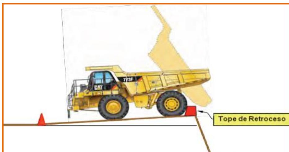
El operador no debe empezar a levantar la caja hasta que el camión se haya detenido completamente. Después de vaciar el material en la tolva, la caja debe bajarse totalmente antes de iniciar nuevamente el movimiento.
