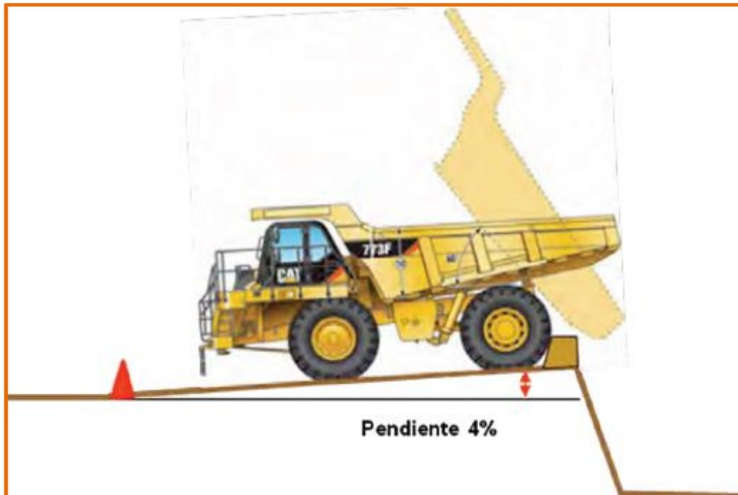
A ambos lados de la zona de descarga deben colocarse conos, de tal forma que sirvan como referencia para que el operador detenga el camión justo antes de llegar al tope de seguridad.
