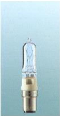
Las lámparas incandescentes halógenas de tungsteno, tienen un funcionamiento similar al de las lámparas incandescentes normales, con la salvedad de que el halógeno incorporado en la ampolla ayuda a conservar el filamento. Aumenta así la vida útil de la lámpara, mejora su eficiencia luminosa, reduce tamaño, mayor temperatura de color y poca o ninguna depreciación luminosa en el tiempo, manteniendo una reproducción del color excelente.
