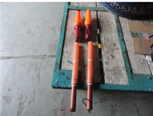
PALILLOS PARA DIRIGIR LA AERONAVE. EN LA PARTE SUPERIOR SE ENCUENTRAN LOS DE TIPO PARA VUELOS NOCTURNOS (TRAE UNA LUZ LED EN LA PARTE INTERIOR), Y EN LA PARTE INFERIOR LOS PALILLOS PARA USO EN LA LUZ NATURAL DEL DIA.
