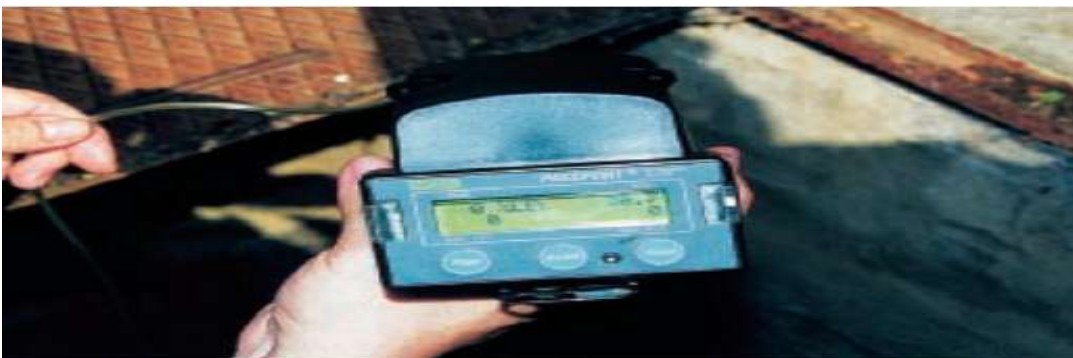
Medición simultánea del índice de explosividad, y de los contenidos de oxígeno, monóxido de carbono y sulfuro de hidrógeno
