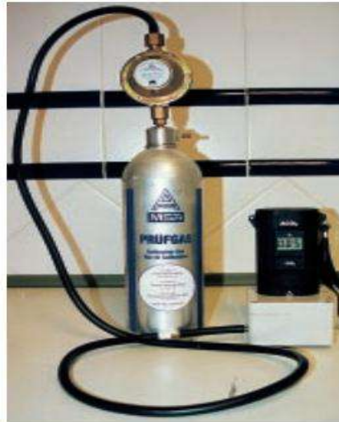
Equipo de calibración con encapsulamiento del sensor del detector
