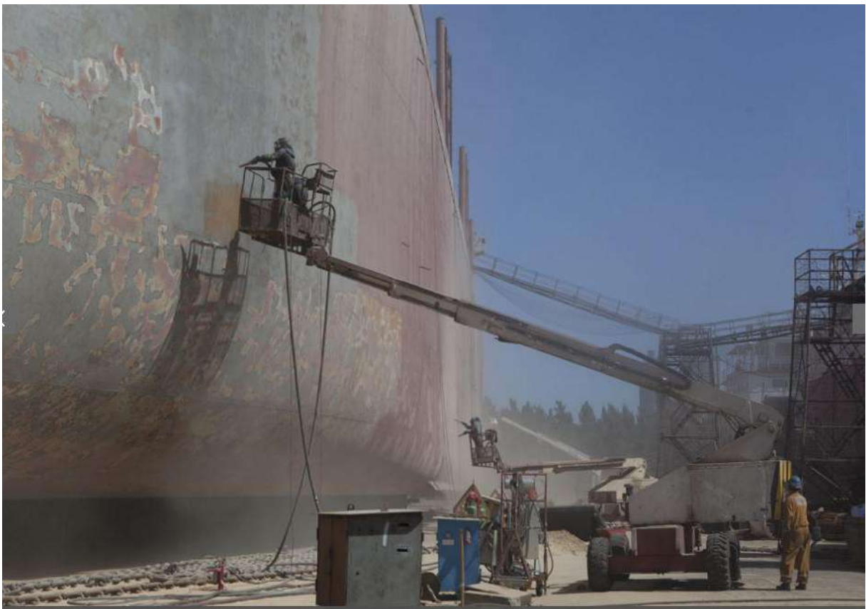
Hidro carenado ( hidro lavadoras de alta presion )
