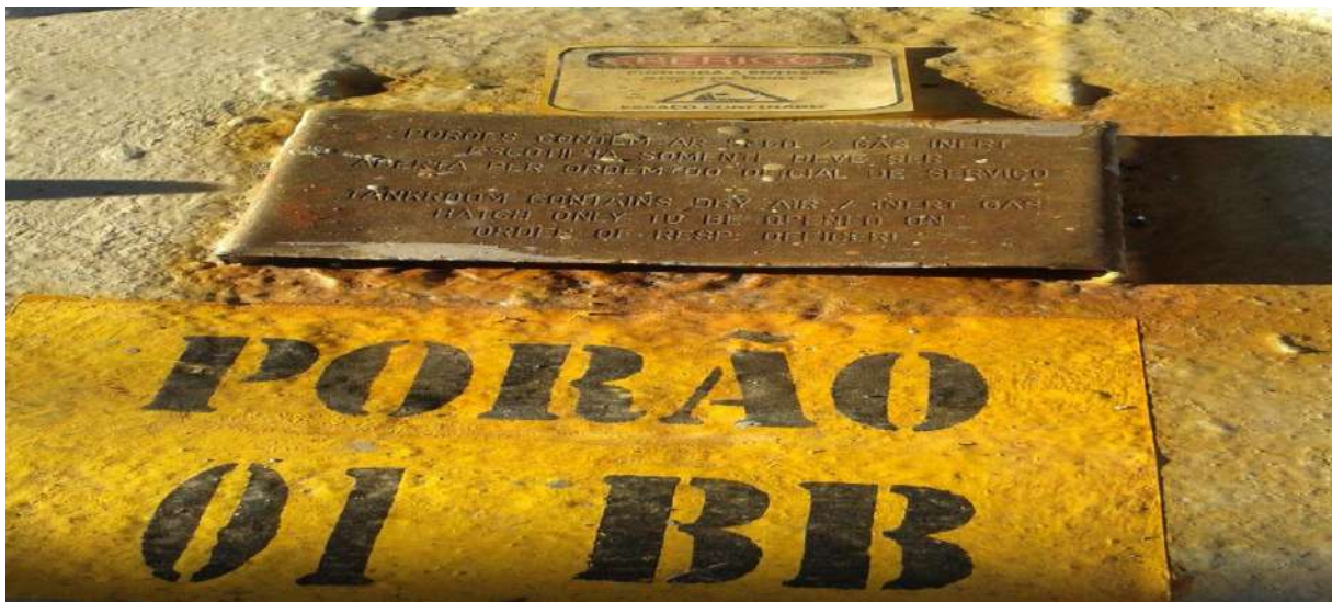
Señalización en escotilla para ingreso a espacio confinado de buque brasileiro
