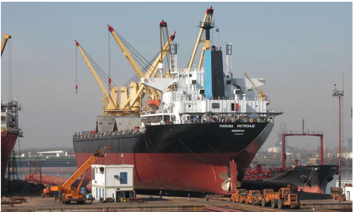
Traslado de un buque del Syncrolift al carro de transferencia
