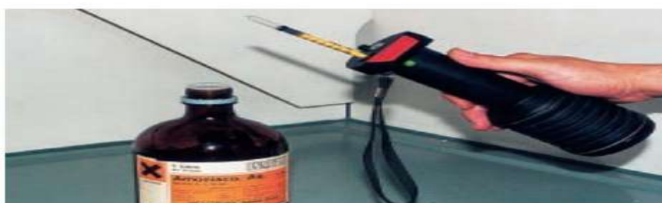
Medición con tubo detector específico cuantitativo para amoniaco
