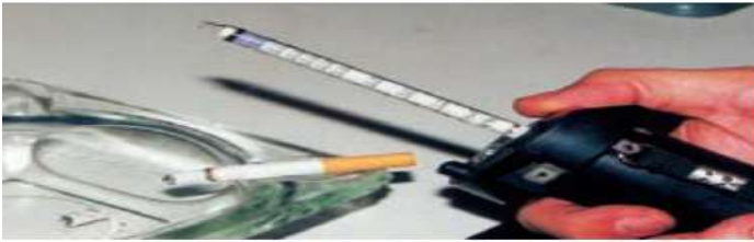
Medición puntual con tubo detector colorimétrico específico para CO 2
