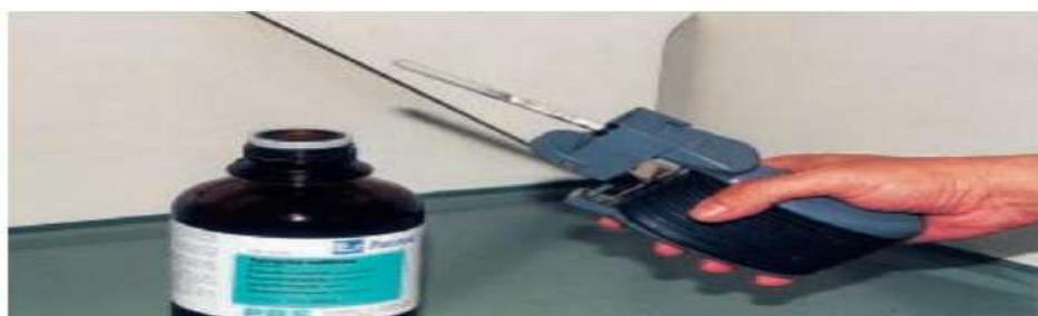
Medición con tubo detector genérico cualitativo (Politest, Qualitest, ...)
