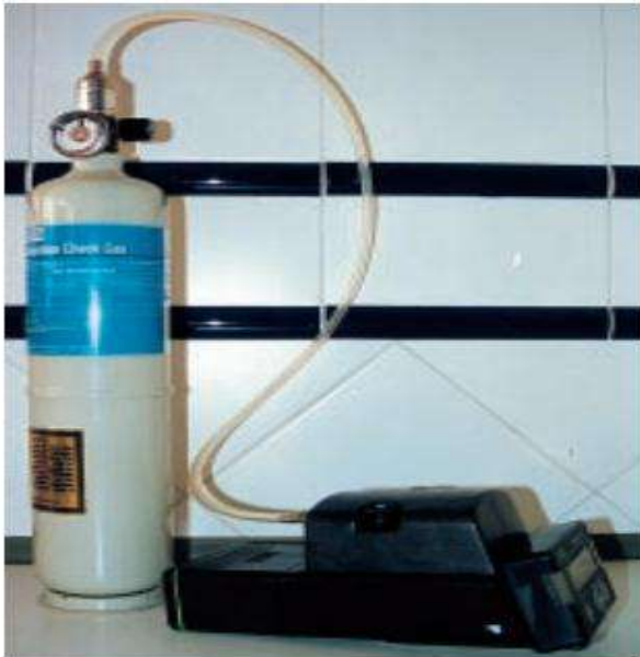
Equipo de calibración con acoplamiento directo de la botella de gases a la bomba de aspiración del detector
