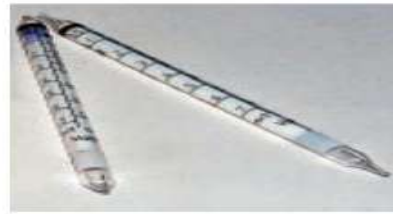
Medición puntual con tubo detector colorimétrico específico para CO 2
