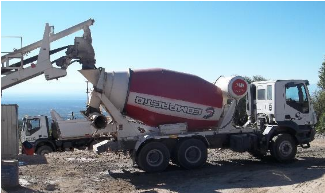
Imagen 29 - Hormigonera montada sobre Camión Iveco
