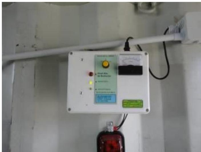
Medidor de radiación en Bunker
