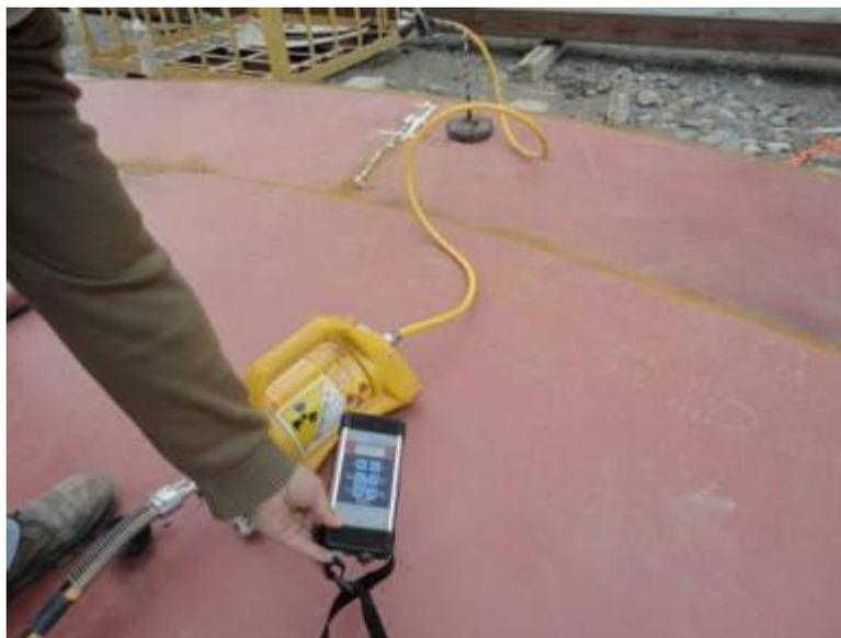
Con el fin de verificar la correcta aislación de la fuente, se realizó una medición de radiación dando como resultado 0,2 milisievert (mSv).
