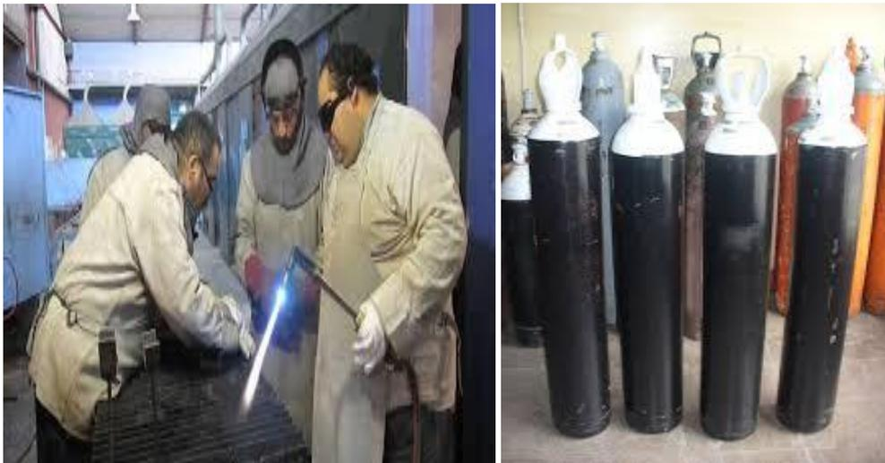
La soldadora se utiliza para arreglos de metales quebrados y el oxicorte para la realización de cortes en metales.
