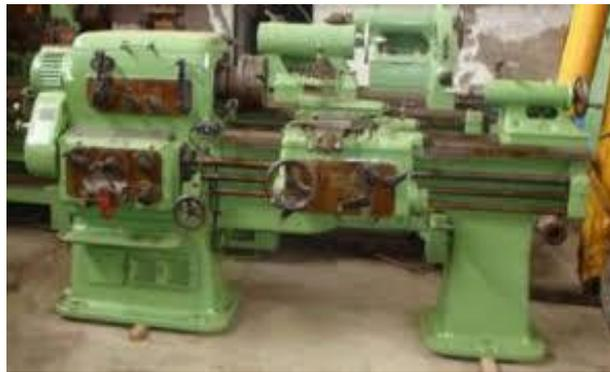
El torno, la máquina giratoria más común y más antigua, sujeta una pieza de metal o de madera y la hace girar mientras un útil de corte da forma al objeto. Utilizado para la fabricación de piezas con distintos escalones de diámetro.
