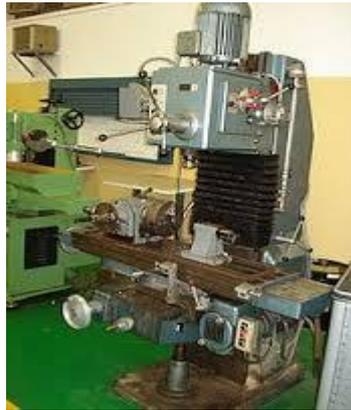
Utilizada para realizar trabajos por arranque de viruta mediante el movimiento de una herramienta rotativa de varios filos llamada fresa.
