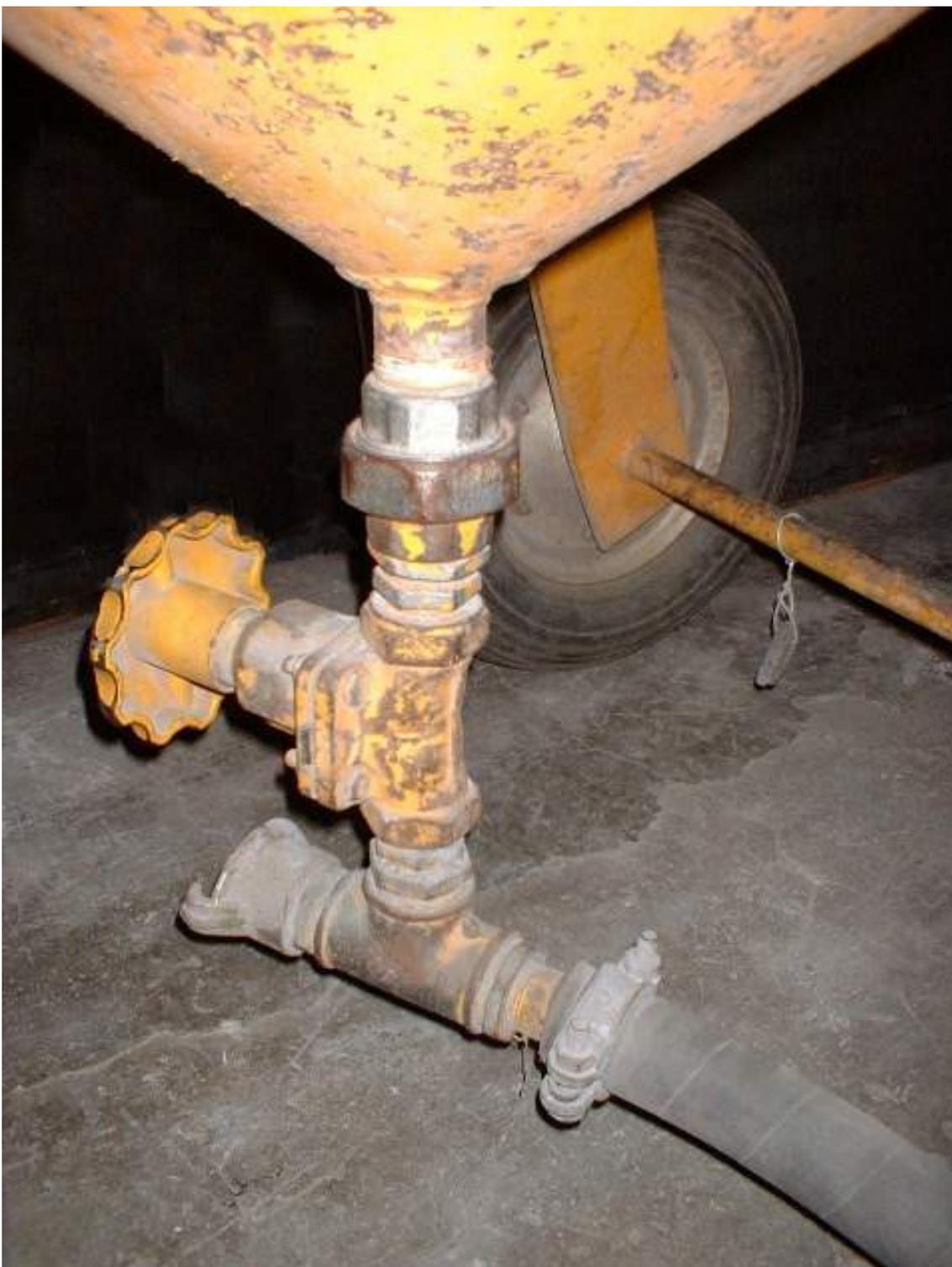
**Foto: Equipo de proyección – Dosificación – Mangueras sin cables de seguridad – Tanque con golpes – Oxidado.**
