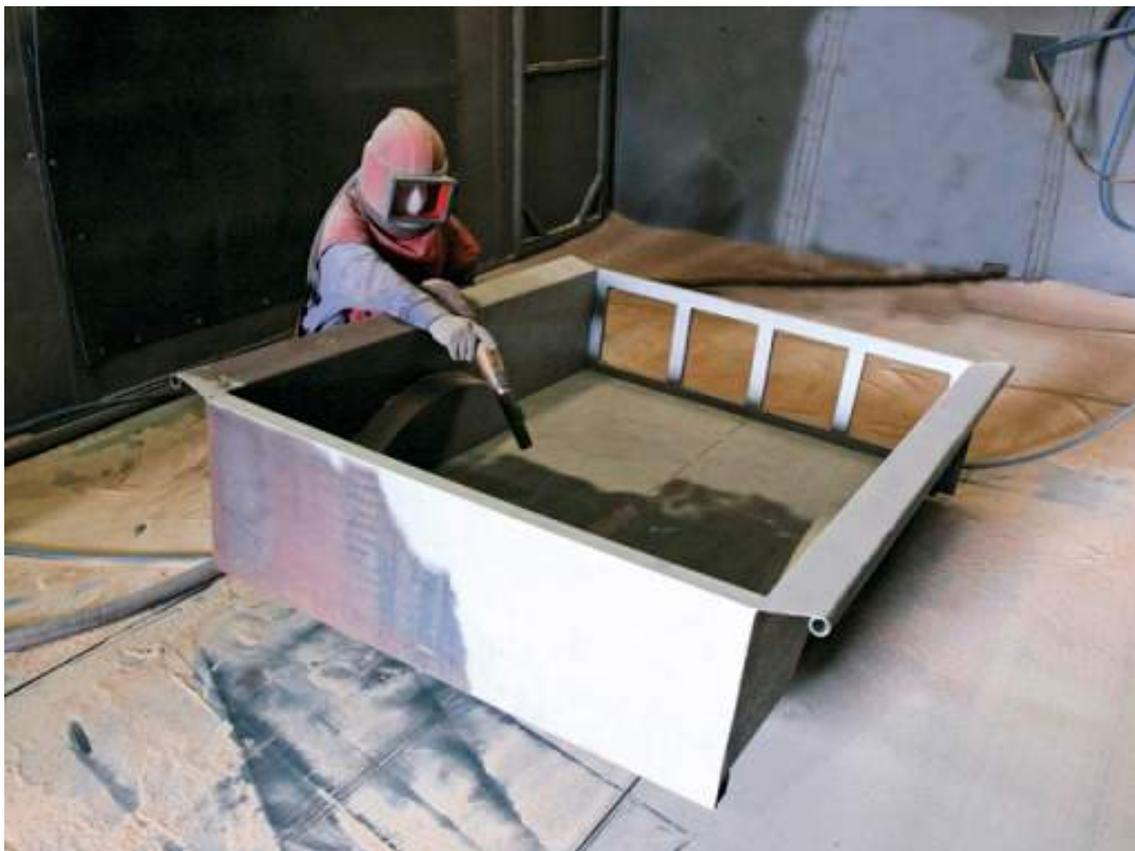
**Foto: Cuarto de arenado – Interior – Utilización de arena como abrasivo - Sin sistema de control a distancia.**
