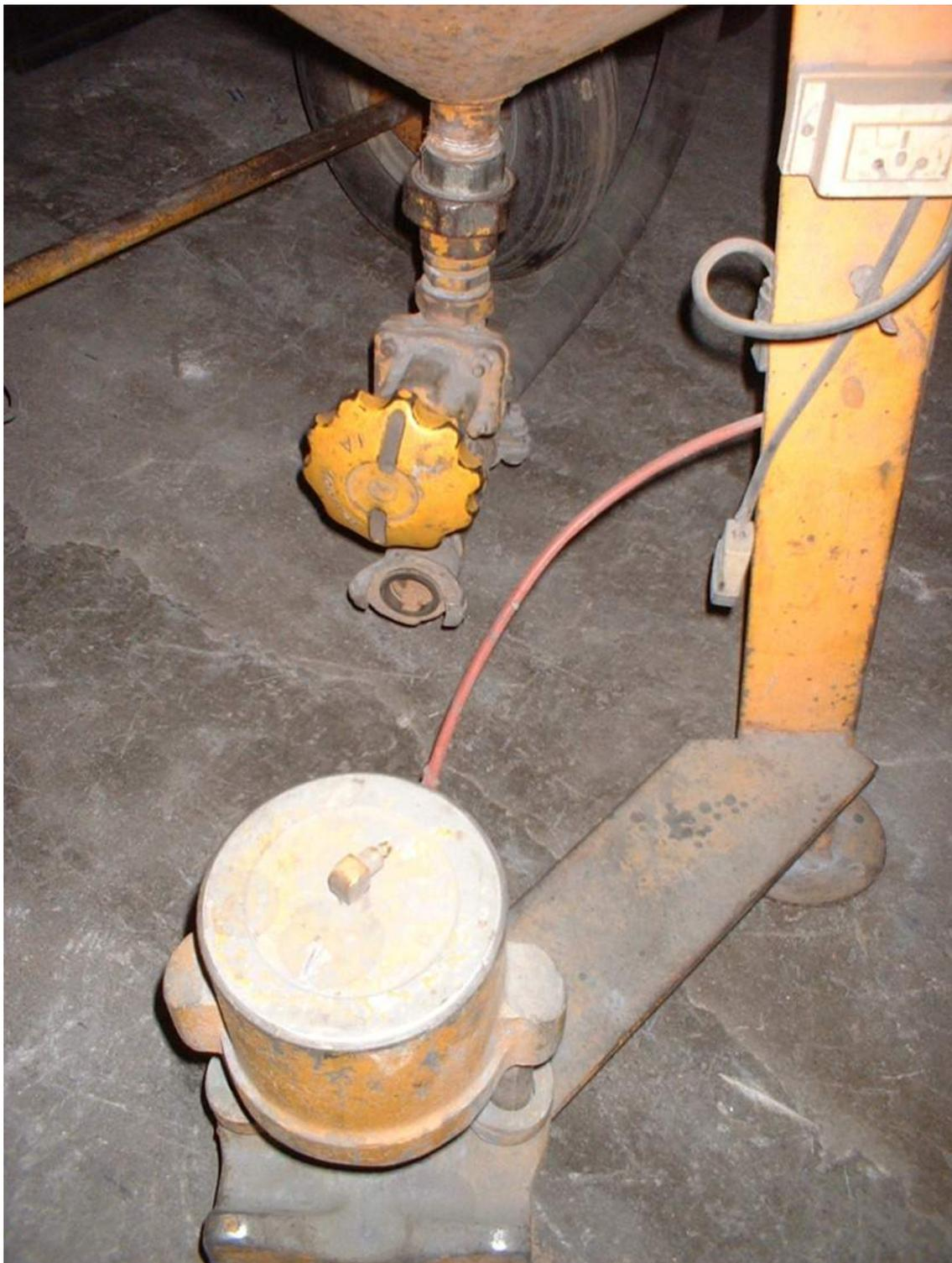
**Foto: Equipo de proyección – Sistema de control a distancia anulado**
