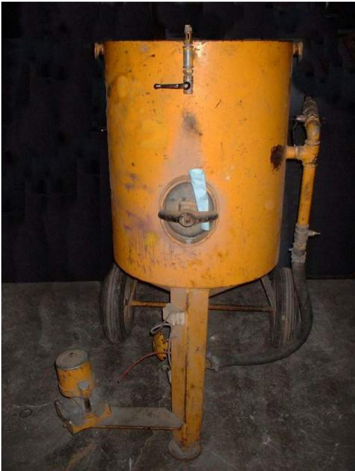
**Foto: Equipo de proyección – Tanque sometido a presión.**
