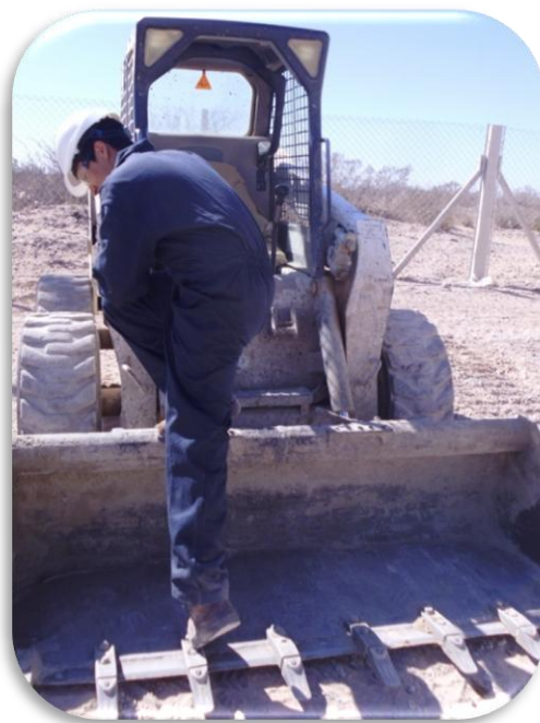
Operario (simulando) al descender pisa mal, apoyando el pie en la uña de la maquina
