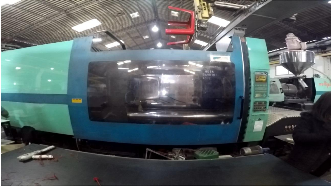
IMAGEN 11: Inyectora produciendo mesas de jardín en pleno proceso.
