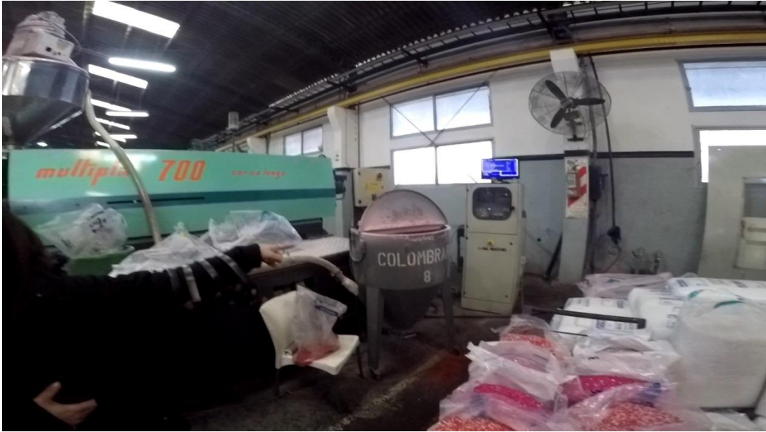
IMAGEN 13: Maquina para la mezcla utilizada para llegar al color final del producto.
