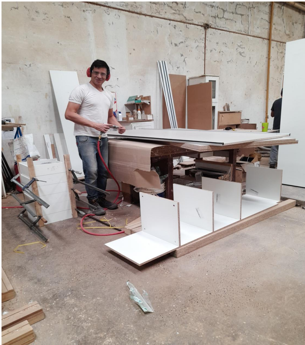
Armado con atornilladora a presión
