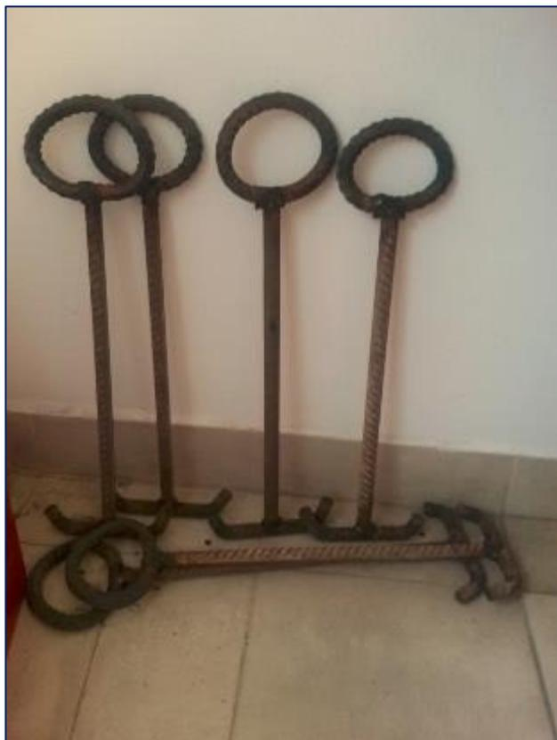
Herramienta diseñada para levantar rejilla.
