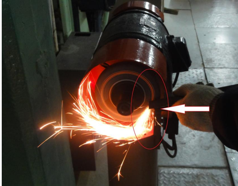
Fotografía 18: pantalla transparente e inastillable.
