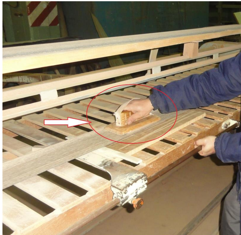
Fotografía 16: riesgo de proyección del útil en lijadora de banco
