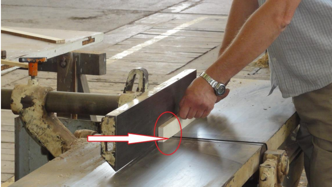
Fotografía 14: riesgo de contacto con la herramienta en tupí
