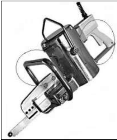
Sierra de pecho Jarvis modelo EBS-1 sin dispositivo de seguridad de doble comando. Opción adoptada por la empresa Friar para utilizar en los procesos del sector Faena.
