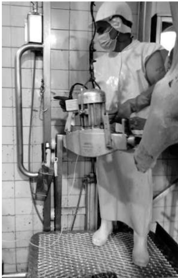
Sierra de pecho Jarvis modelo EBS-1 sin dispositivo de seguridad de doble comando. Opción adoptada por la empresa Friar para utilizar en los procesos del sector Faena.
