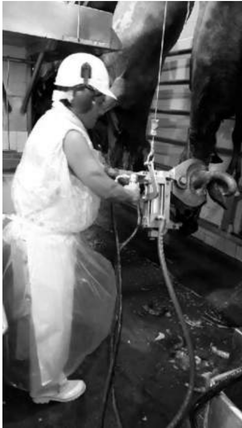
Descornadora Jarvis modelo 25DN Con dispositivo a dos mandos adaptado.
