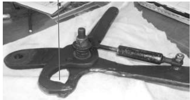
Diseño de gancho de acero adaptado para izar bovinos con aparejo, con dispositivo de seguridad tipo pestillo que se abre de forma mecánica para liberar la carga una vez posicionada. Cumple con lo estipulado en el Decreto 351/79 art. 126.
