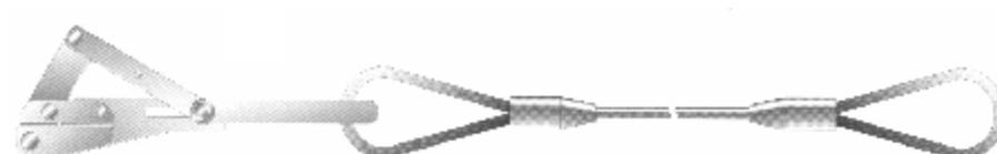
La Mordaza o Rana se usa para sujetar y asegurar el cable mientras se está alzando o bajando (tumbando) el Lubricador con la sarta de herramientas en su interior, de igual forma que cuando se deja la sarta de herramientas colgando dentro del pozo (registros de presión).
