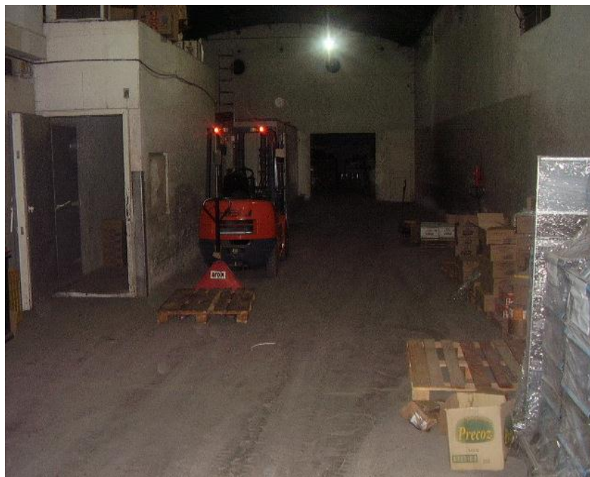
Falta de señalización del pasillo de circulación del auto elevador.
