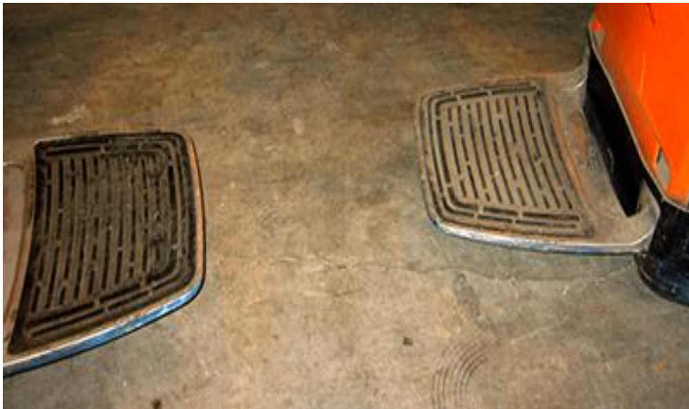
Detalle de la plataforma abatible de la transpaleta
