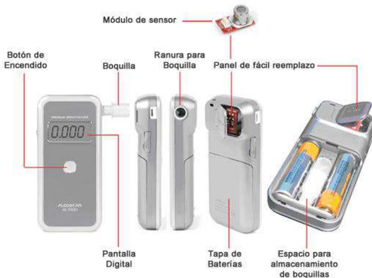
Fig. 1 –Características y componentes del equipo “Alcoholímetro”.
