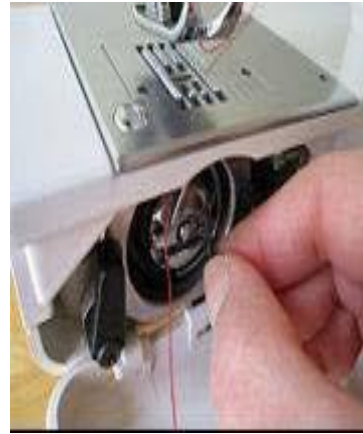
Colocación de la bobina
