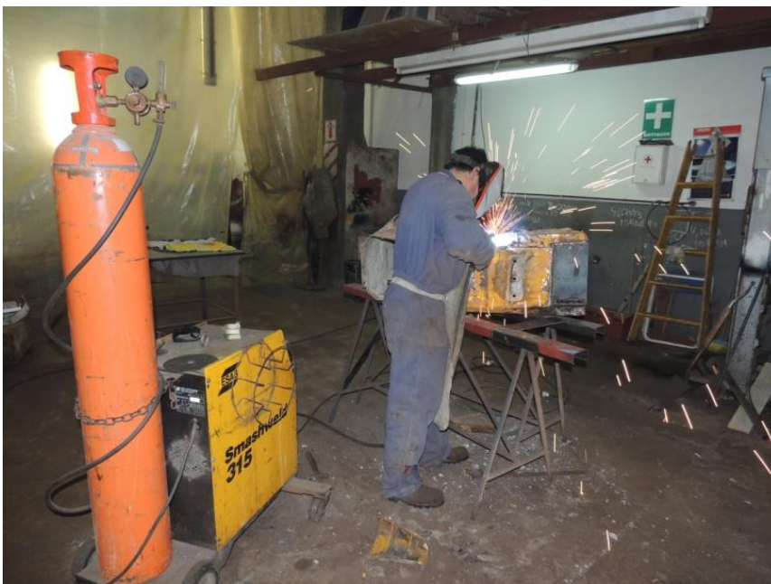
Soldadura por arco eléctrico
