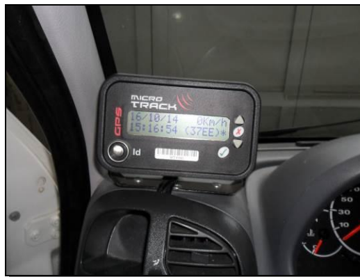
Figura 21 – Dispositivo de seguimiento satelital.
