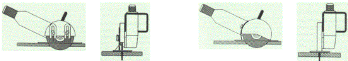
Figura 37 – Guía para cortes perpendiculares con profundidad graduable.
