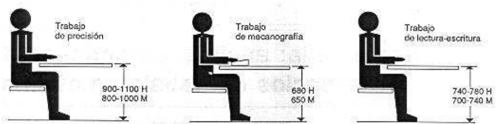
Figura 1: altura del plano de trabajo para puestos de trabajo sentados (cotas en mm)
