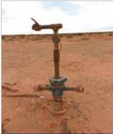
Foto 14- Boca de Pozo
