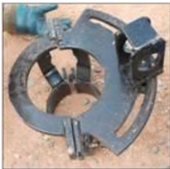
Foto 12 y 13- Sistema ideado por el personal para el desenrosque de la cabeza de pozo
