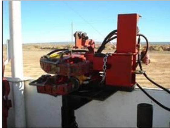
Foto 10- Llave Scorpión Instalada en el equipo
