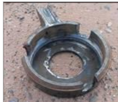
Foto 12 y 13- Sistema ideado por el personal para el desenrosque de la cabeza de pozo
