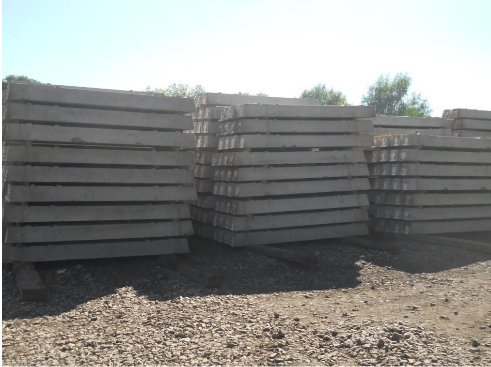
Fotografía N° 24 – Estiba de durmientes nuevos
