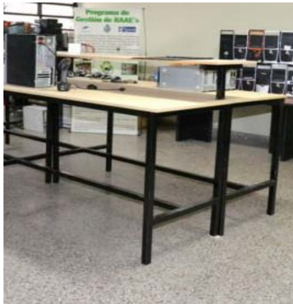
Figura 6.4. Banco de trabajo ergonómico para desguace y curso de reparación
