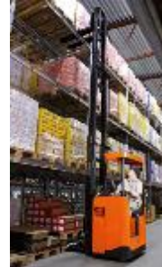
Apiladora tomando producto desde niveles elevados
