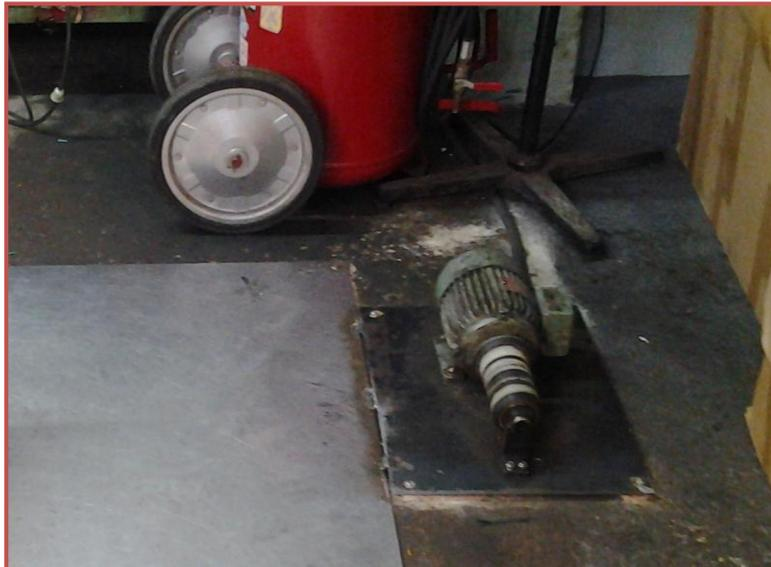
El rodillo de prueba es un dispositivo donde se apoya la rueda delantera del moto vehículo haciéndola rodar y verificado el funcionamiento del velocímetro.
