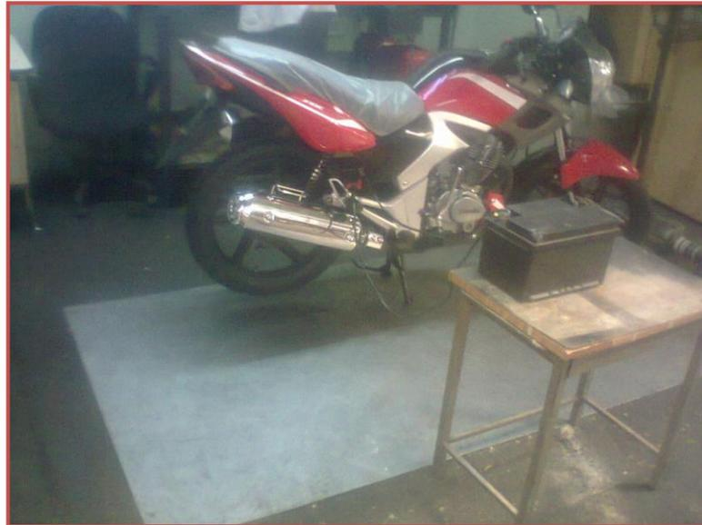
La prueba del moto vehículo se realiza sobre una planchada de acero para evitar que todo derrame accidental de fluidos pueda ser absorbido por el suelo y facilitar su remoción y limpieza.
