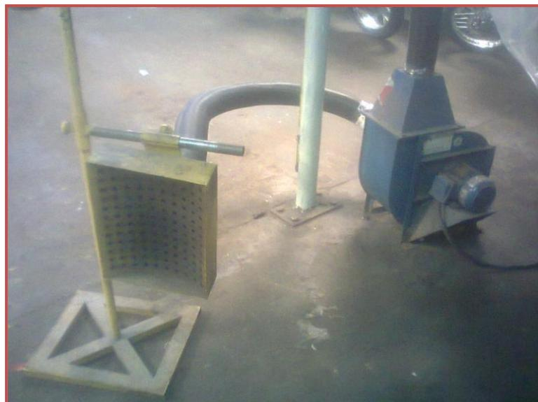
El sistema de extracción de gases cuenta de una campana y un motor de extracción forzada retirando todo gas expulsado por el caño de escape del moto vehículo.
