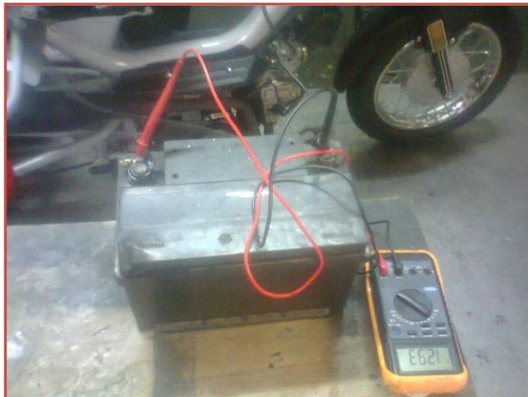
La batería para realizar el encendido del moto vehículo. Con el tester se comprueba el buen funcionamiento eléctrico.
