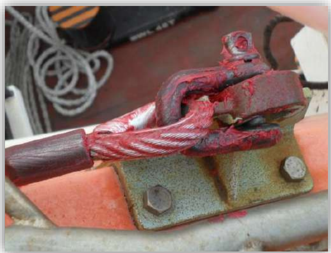
Foto 77: sistema de sujeción de botes salvavidas, en la inspección anual de seguridad es engrasado para su perfecto estado de conservación. Fuente, elaboración Propia.
