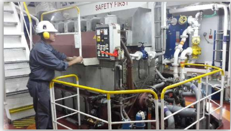
Foto 24: Sistema de control de alimentación del motor principal. Fuente: elaboración propia
