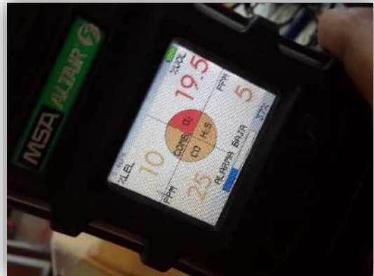
Foto 33: Detector MSA ALTAIR, detección de sulfuro de hidrógeno (H 2 S), monóxido de carbono (CO), oxígeno (O 2 ) y límite inferior de explosividad (LEL). Fuente, elaboración propia.
