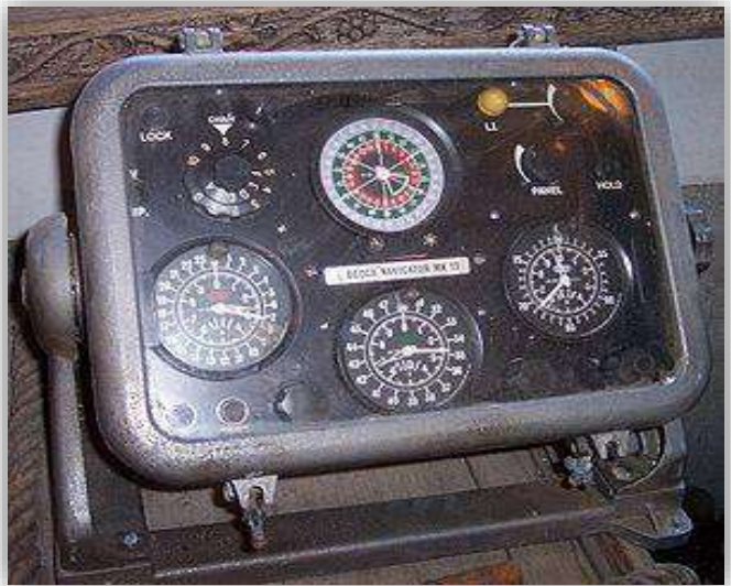
Foto 14: antiguo sistema DECCA modelo Navegador Mk 12 Funcionaba por interferencia entre las señales de emisión y recepción, entre equipo Maestro v Esclavo. Fuente wikipedia
