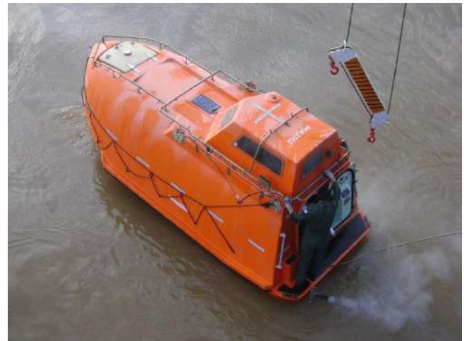
Ilustración 97: Bote salvavidas en simulacro de abandono. Esta embarcación cuenta con sistema de enfriamiento externo con agua para disminuir la temperatura al navegar sobre hidrocarburos encendidos. Fuente, elaboración propia.
