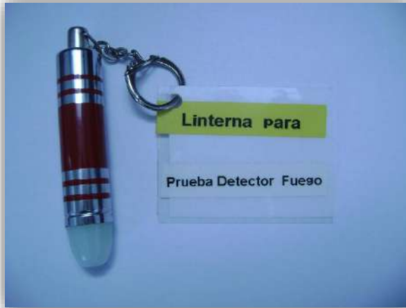
Foto 43: Linterna usada en Foto 16, para activar o simular una situación de fuego o llama activando o cambiando de estado la salida del detector. Fuente, elaboración propia.
