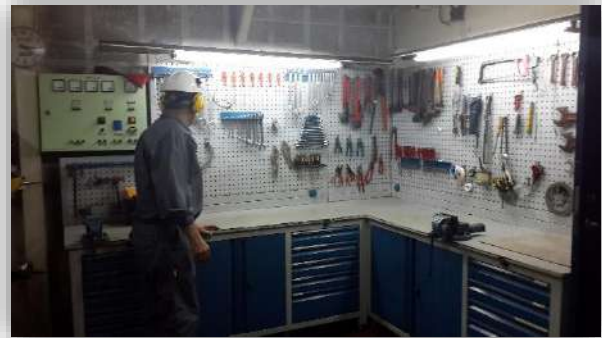
Foto 31: Iluminación de banco de trabajo con tubos fluorescentes, la intensidad de la iluminación es buena, pero con peligro de efecto estroboscópico. Fuente, elaboración propia.
