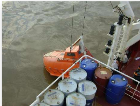
Ilustración 98: el bote salvavidas puede arrojarse desde el buque (Free Fall) o descender con cabos de acero para las maniobras de prueba en cualquiera de las dos formas el motor debe estar en marcha, y las personas adentro del mismo. Fuente, elaboración propia.
