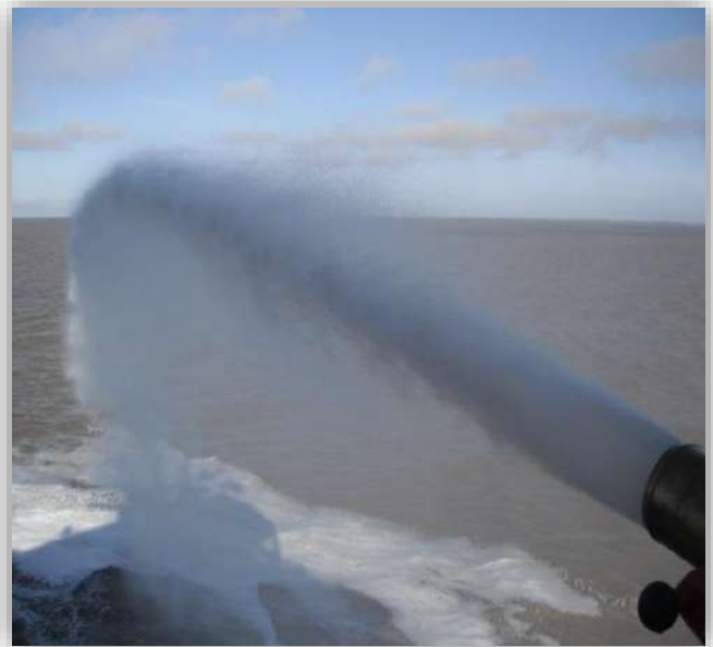
Foto 60: Monitor de espuma en acción sobre la cubierta principal, simulacro "Pampa sur B". Fuente, elaboración propia.
