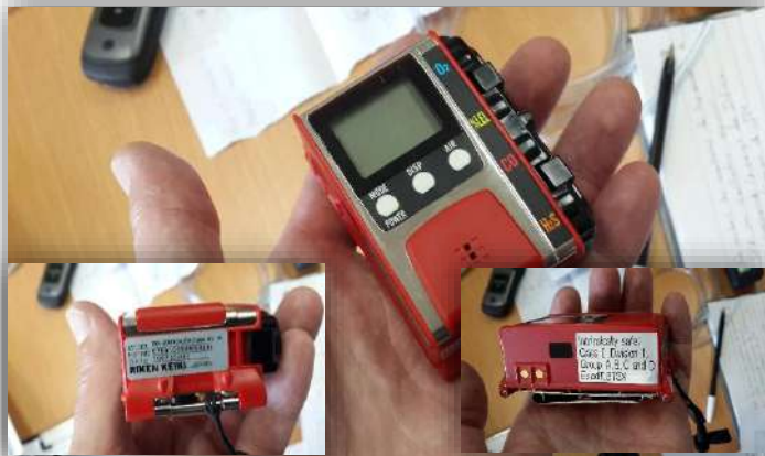
Foto 34: Detector de gases RIKEN KEIKI, alarma sonora (95dB @ 30cm), puede ser usado en áreas explosivas. Fuente, elaboración propia.
