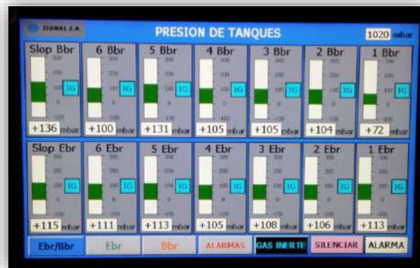
Foto 39: Las bodegas de transporte de carga están presurizadas con gas inerte antiexplosivo para eliminar gases de combustible en espacio vacío de los tanques.
