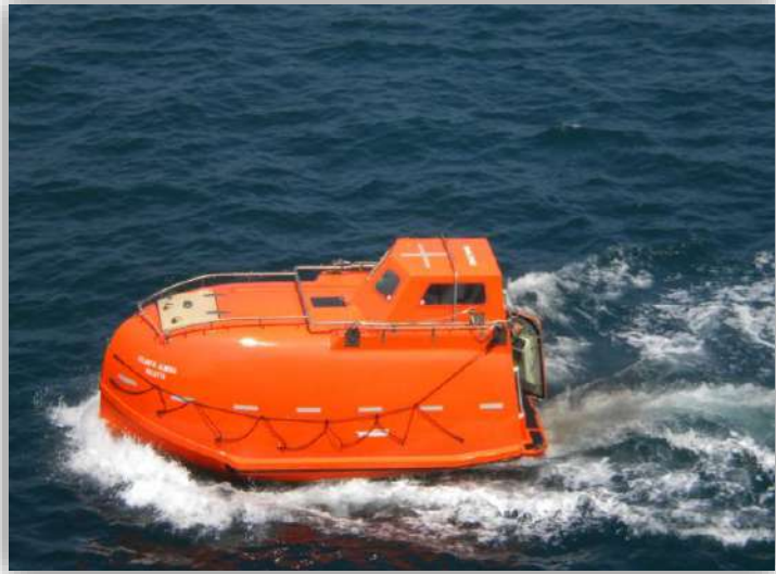
Foto 80: prueba de bote Free Fall, en las inspecciones de seguridad se controla el perfecto funcionamiento de motores y sistema de alimentación de Oxígeno. Fuente, elaboración propia
