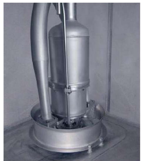
Foto 5: Bomba FRAMO en el interior de una cisterna de acero inoxidable especial para transportar productos químicos. Fuente: www.framo.com
