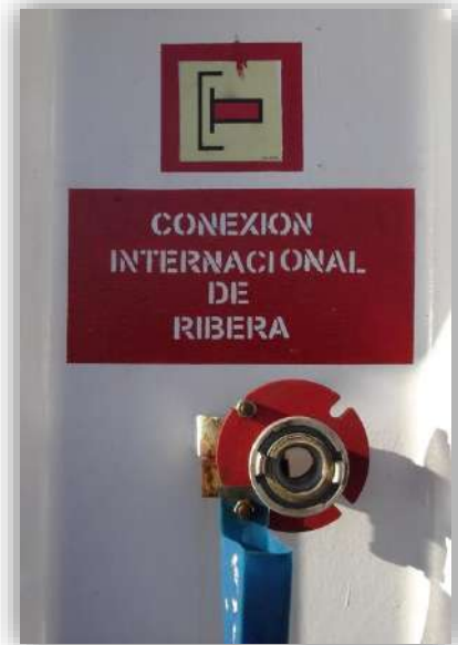
Foto 46: Disposición internacional obliga a las embarcaciones a contar en forma accesible sobre la cubierta principal un adaptador de conexión de agua de incendio. Fuente, elaboración propia.
