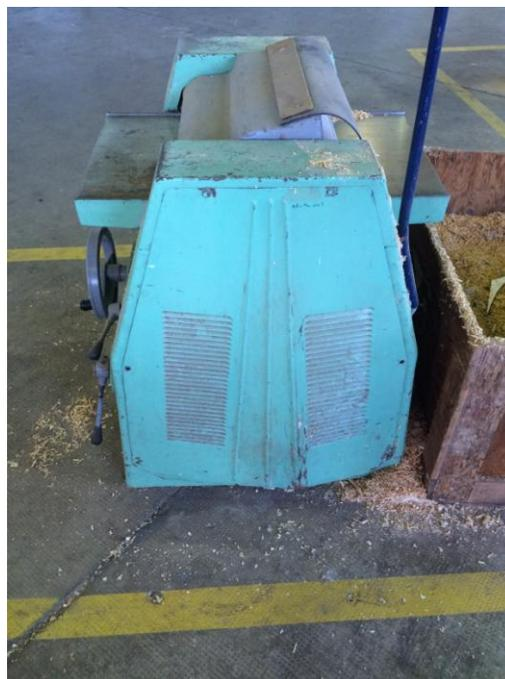
Foto 1.12: Tapa protectora de mecanismos internos
