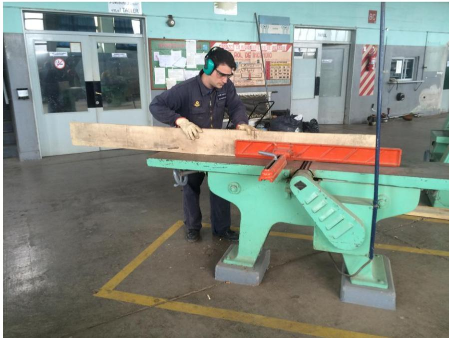
Foto 1.14: Operación de mecanizado o desbaste con la Garlopa
