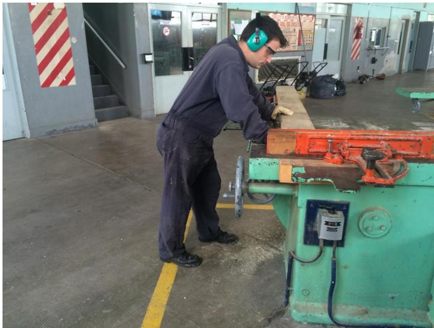
Foto 1.13: Operación de corte con la Sierra Circular
