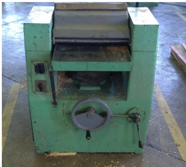
Foto 1.10: Zona de ingreso de las piezas, manivelas de ajuste e interruptor de puesta en marcha
