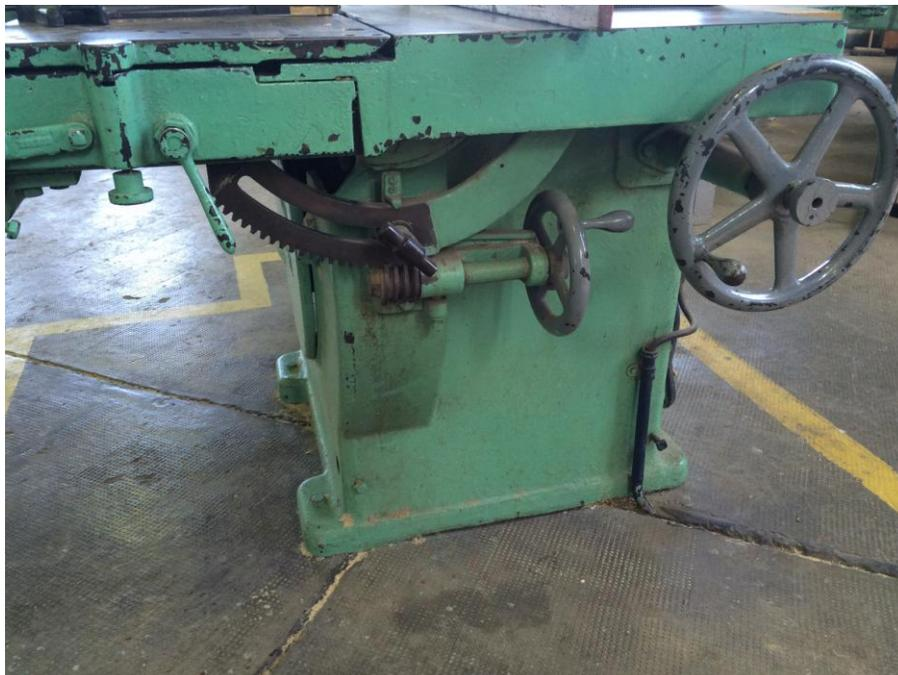
Foto 1.6: Manivelas de ajuste de inclinación de la mesa y regulador de altura de la hoja de sierra
