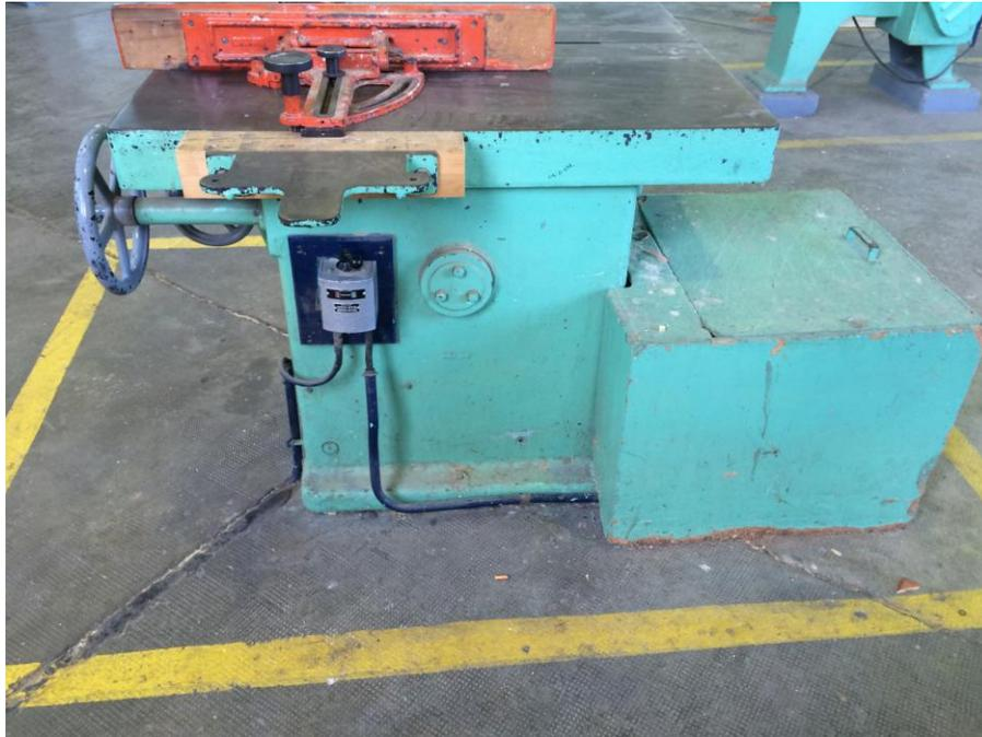
Foto 1.5: Interruptor de puesta en marcha y cajón cubre polea
