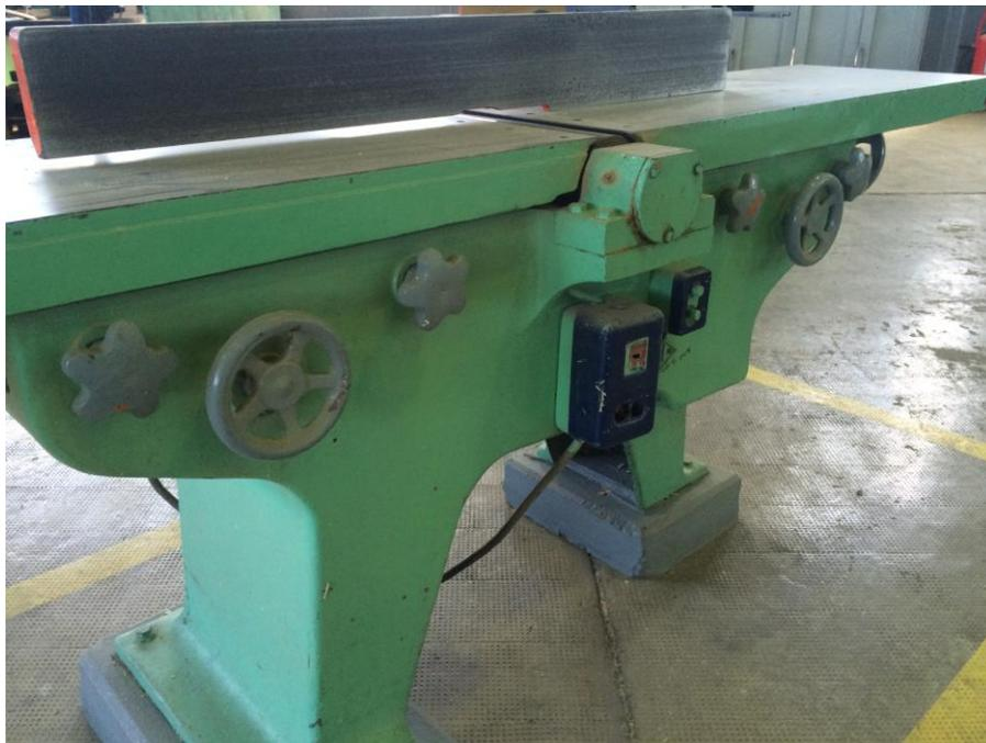
Foto 1.9: Bastidor o base e interruptor de puesta en marcha
