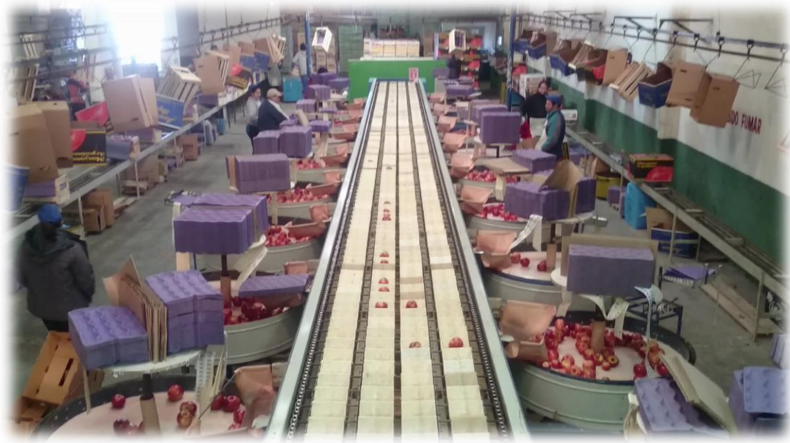
Imagen 4 – Cadena inteligente y tambores de acopio para su embalaje
