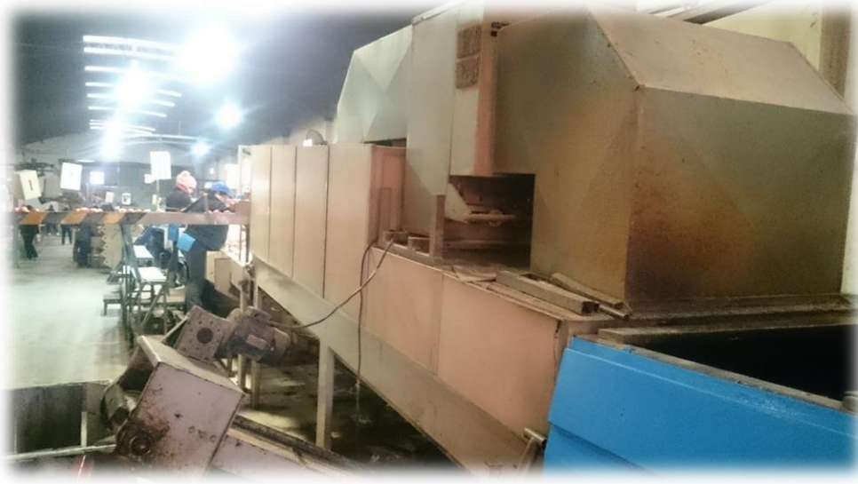
Imagen 26 – Túnel de secado
