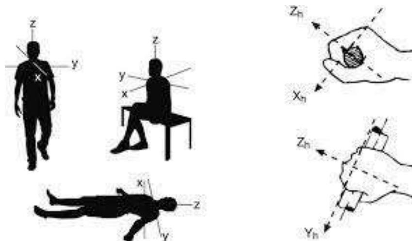
Las vibraciones de cuerpo completo son aquellas transmitidas por los asientos de los vehículos, o aquellas transmitidas por maquinas, plataformas o pisos. En el caso de las vibraciones del sistema mano- brazo, quedan incluidas aquellas que son transmitidas por herramientas manuales (taladros, amoladoras o equipos de trabajo que se sujeten con las manos, como palancas o volantes)
