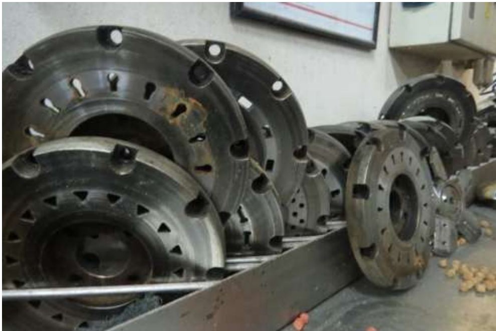
Imagen 2.10 Matrices de máquina extrusora
