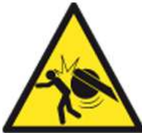
Imagen 2.22 Señalización riesgo golpes o choques con objetos
