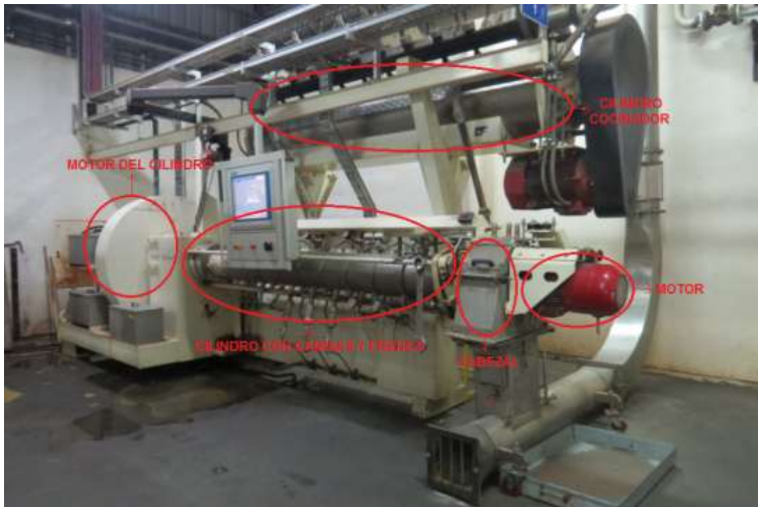
Imagen 2.7 Máquina extrusora y sus partes
