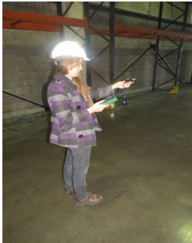
Imagen 2.42: Medición con luxómetro
