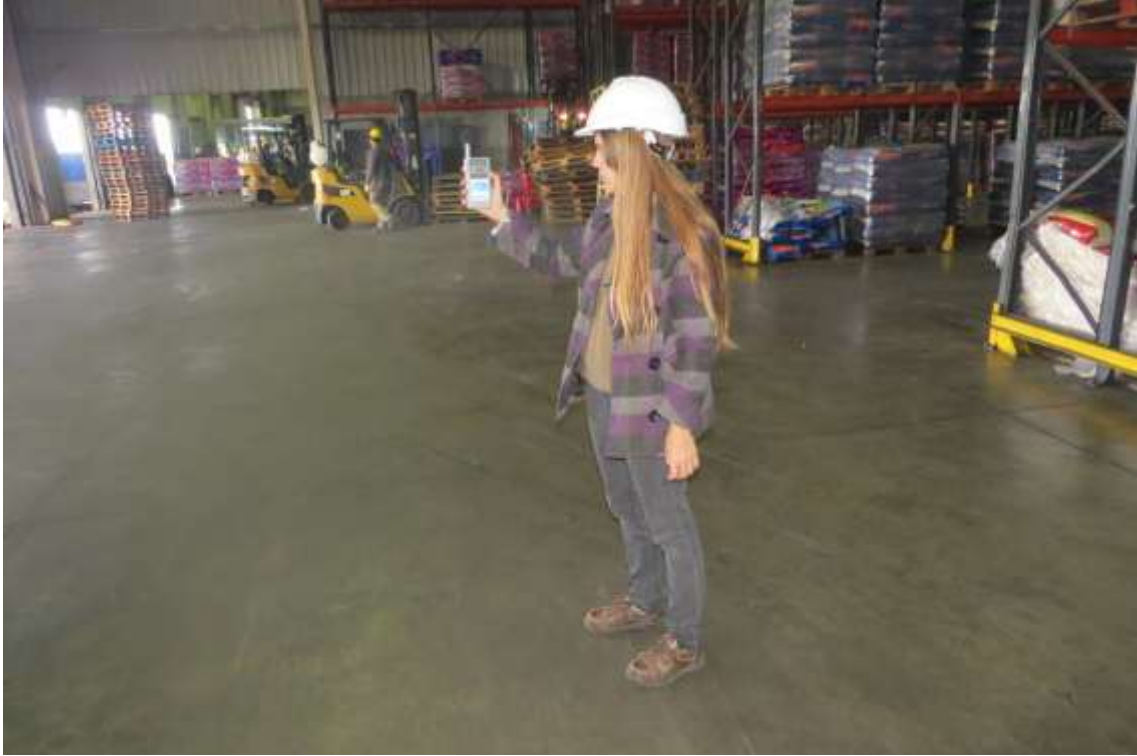
Imagen 2.44: Medición con decibelímetro
