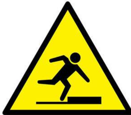
Imagen 2.24 Señalización riesgo caída al mismo nivel
