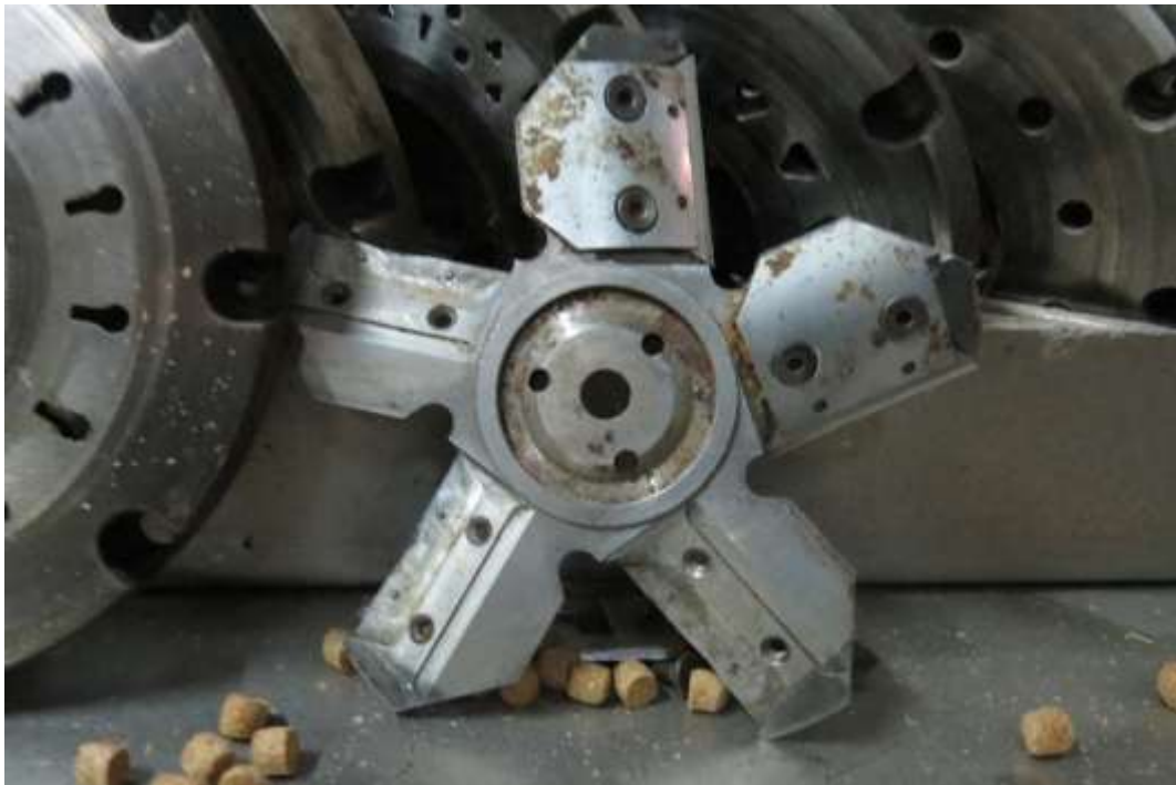
Imagen 2.11 Cuchilla de máquina extrusora
