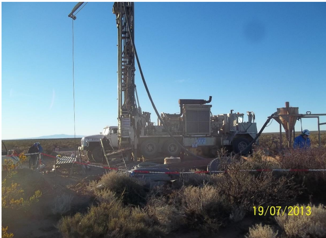
Figura: equipo perforador con guinche para izaje de materiales.
