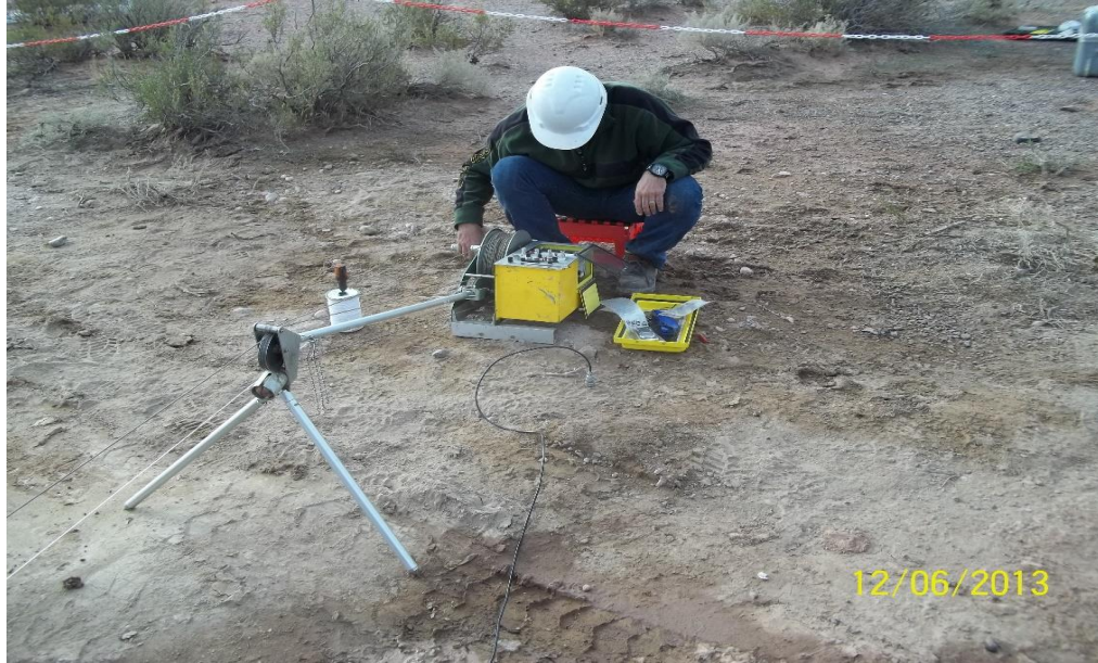
Figura: se realiza perfilaje de pozo freatico para descripcion litologica y parametros de referencia de los acuíferos
