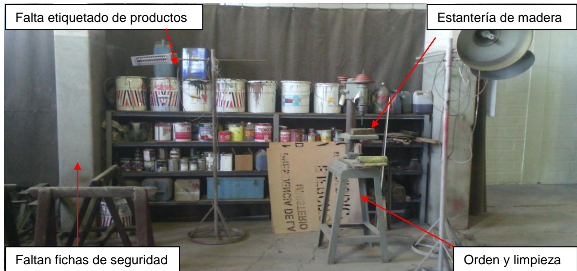
Figura 2.2: Almacenamiento de pinturas y solventes
