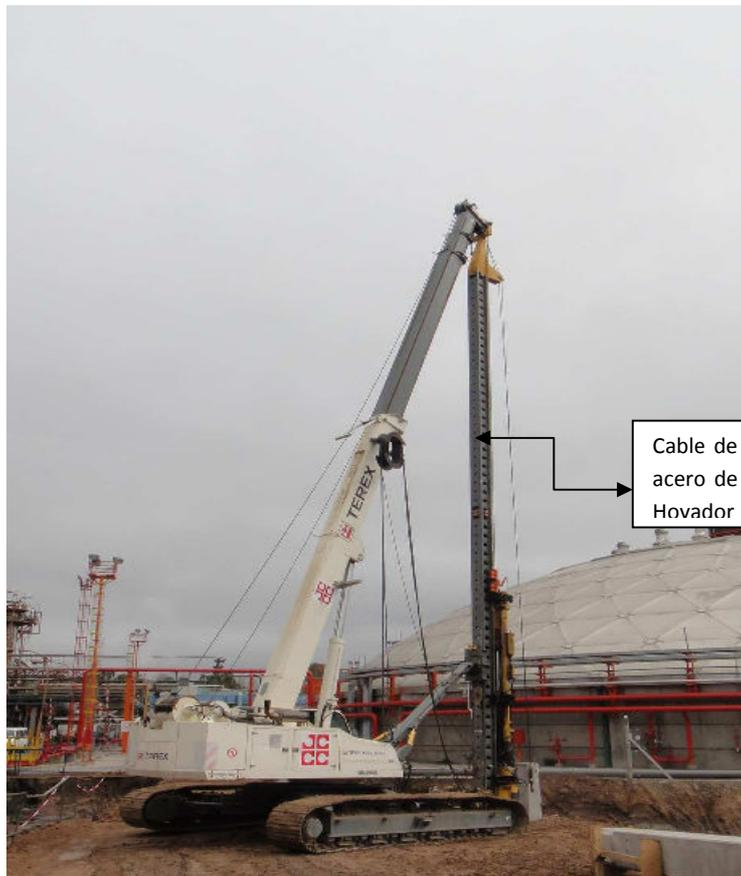
Figura N° 22 Cable de Hoyadora
