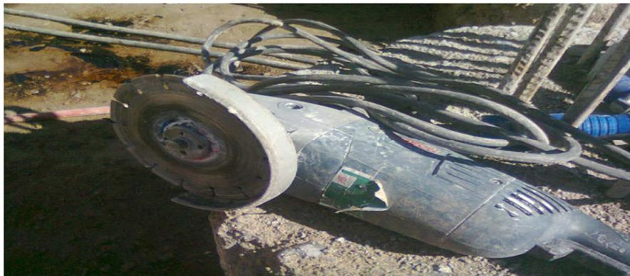
**Amoladora que no cumple las medidas de seguridad (mal colocación de protección de disco, falta de empuñadura).**
