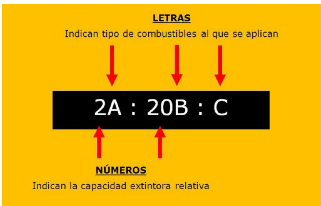
Figura 2.28 Clasificación e identificación de extintores. Ing. Néstor Adolfo Botta.
