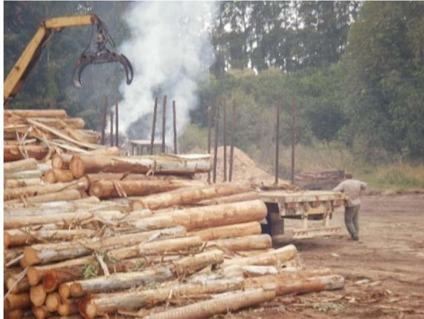
Figura 3.12 operario esperando a distancia no adecuada.
