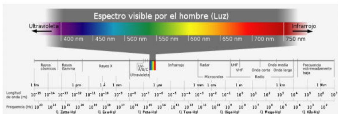
Figura 2.12 .Espectro visible por el hombre. Guía práctica Nro. 1. Superintendencia de Riesgos del Trabajo.
