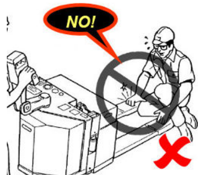
Ejemplo manipulación de rodamientos de la zorra eléctrica, es acto inseguro.
