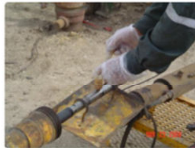
Pie de Foto Carga de Motor Ejector con Fluido Radioactivo
