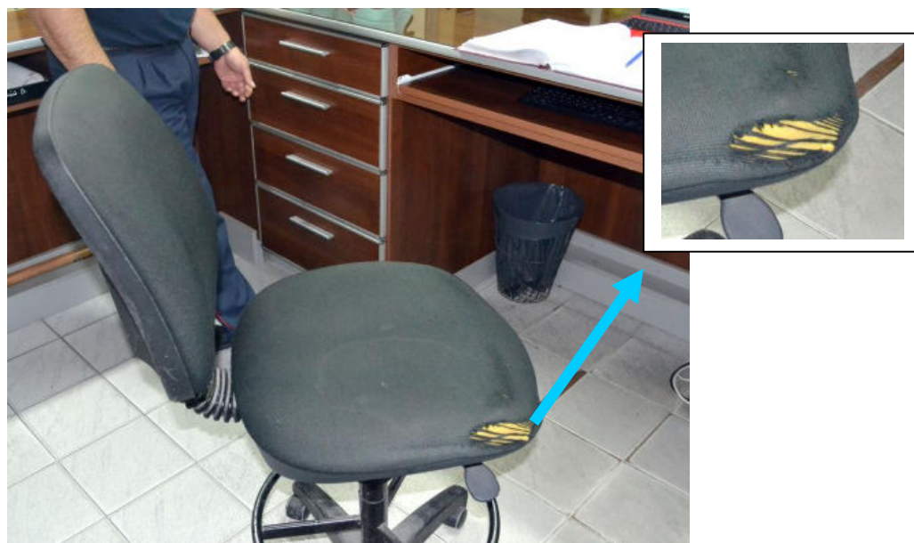
Desgaste de la silla deja expuesto parte cortante de la estructura de la misma.
