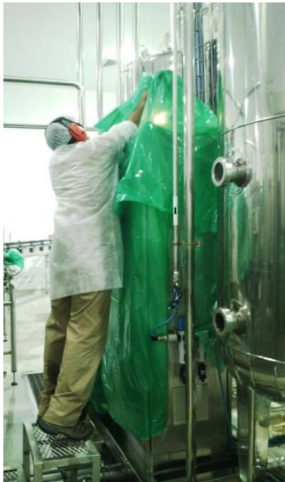
Fig. N° 16 – Personal cubriendo instalación eléctrica.
