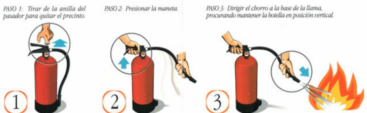
Imagen N°19 La manera correcta de utilizar un extintor.
