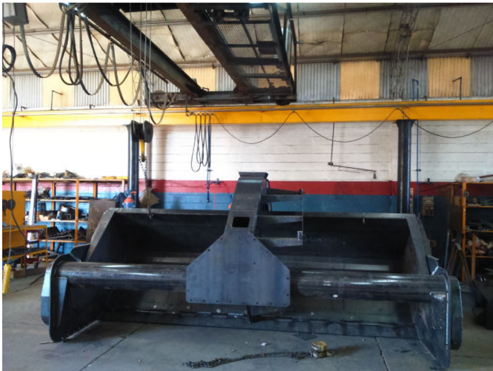
Imagen N° 13 Pala Niveladora terminada
