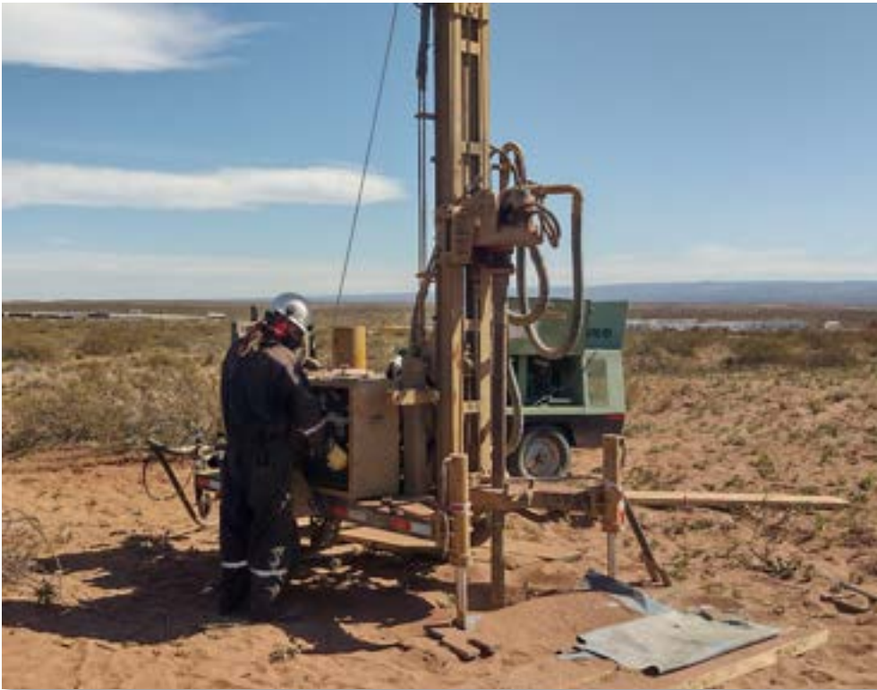
Sector de mandos, sitio en el que se ubica el jefe de Perforación
