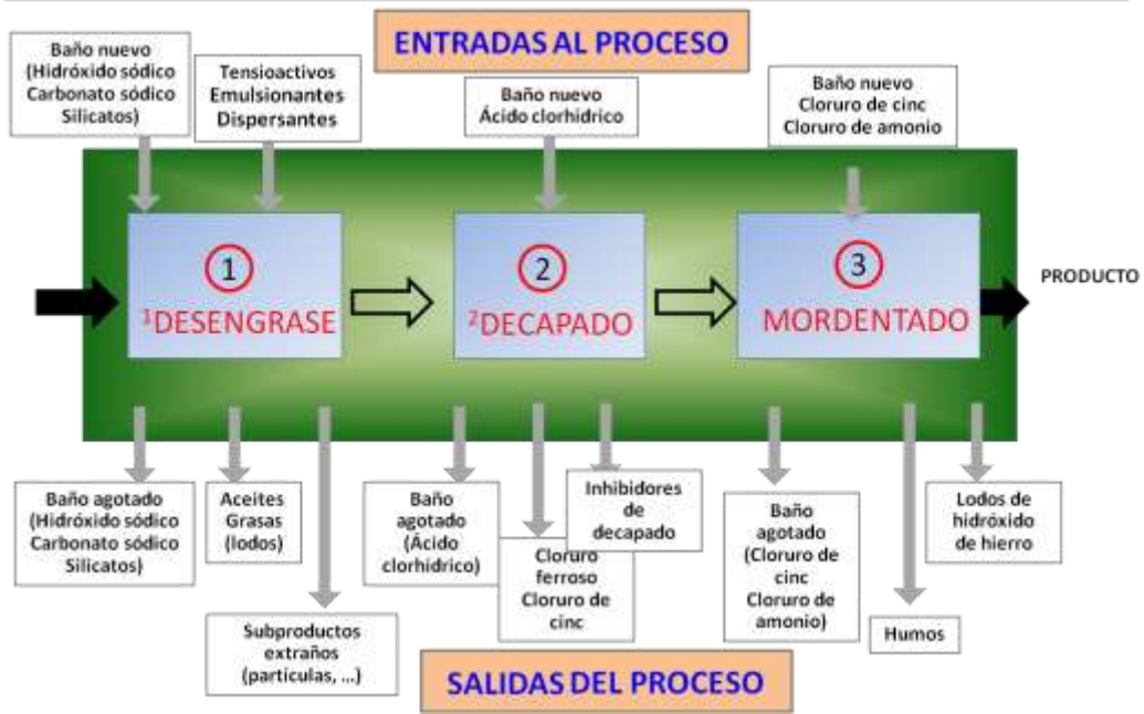
Diagrama de flujo general de un proceso de preparación de piezas para galvanizado.
