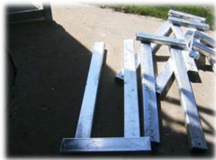
Pieza galvanizada finalizada
