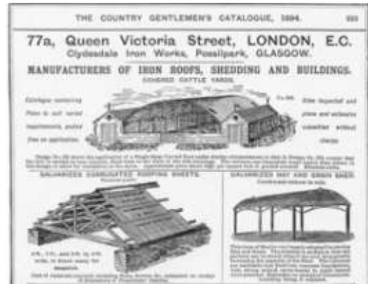
Construcciones de chapa galvanizada según el método Morewood & Rogers (Publicación de 1894)
